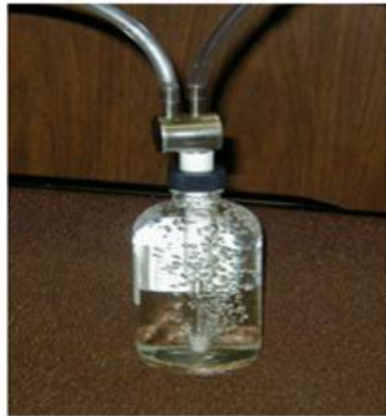
Şekil 3.2. Köpüren su örneğinin RAD7 detektörüne bağlanması
