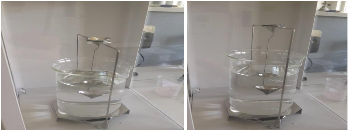
Şekil 3.5. Hassas terazi yoğunluk ölçüm kitiyle hava ve suda yoğunluk ölçümü
