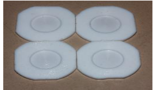
Şekil 3.4. Su emme ve çözünürlük test numuneleri hazırlanmak için kullanılan kalıplara ait model ve fotoğraf
