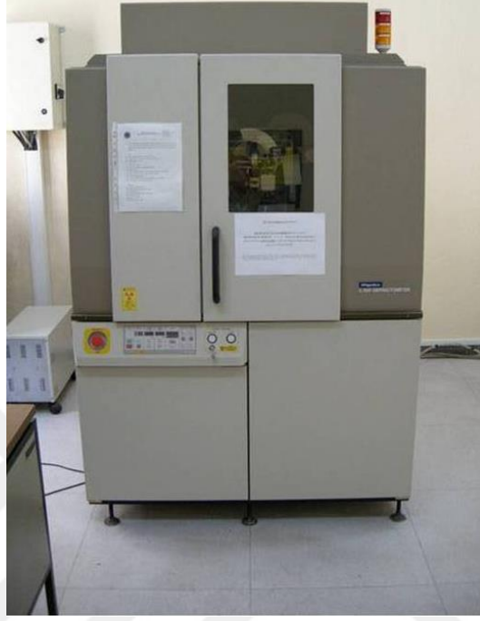
Şekil 3. 7. XRD cihazı (Rigaku, D/Max-2200).
