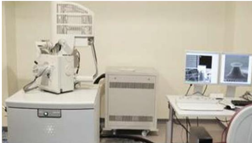
Şekil 3. 5. SEM cihazı (Quanta 200 FEG SEM).
