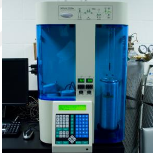
Şekil 3. 6. BET cihazı (Quantachrome Nova 2200 BET).
