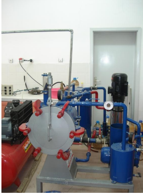
Şekil 4. Laboratuvar tipi silindirik emprenye kazanı
