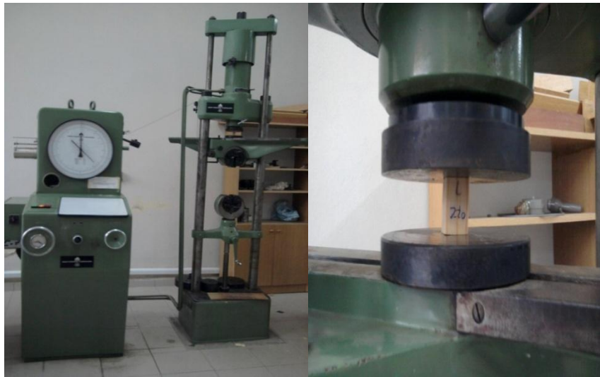
Şekil 6. Liflere paralel basınç deneyinin gerçekleştirilmesi
