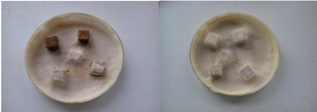
Şekil 8. Mini - blok mantar çürüklük testinin uygulanışı
