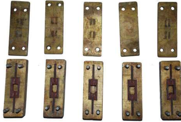
Resim 18: Kalıp içine yumuşak astar maddesinin yerleştirilmiş durumu
