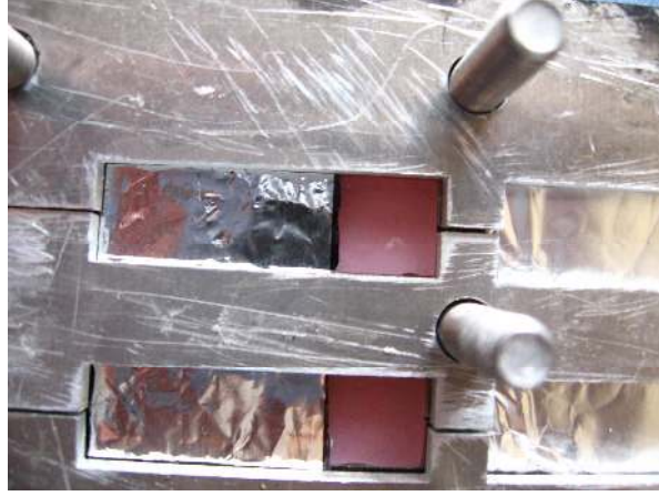
Resim 9: Molloplast-B'nin yerleştirileceđi negatif boşluđun yakın görünümü.
