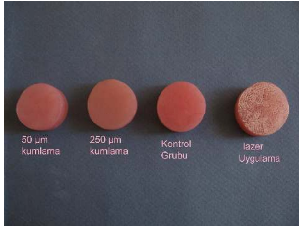
Resim 2: Pürüzlendirme işleminden sonra örneklerin yüzey görünümü.
