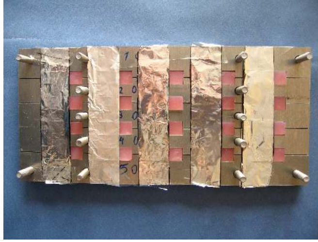
Resim 7: Akrilik örneklerin Molloplast-B yumuşak astar maddesinin bağlanmaması istenen yüzeyinin alüminyum folyo ile kapatılması.
