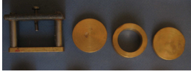
Resim 1: Yüzey pürüzlülüğünün değerlendirilmesinde kullanılacak örneklerin hazırlandığı pirinç kalıp.
