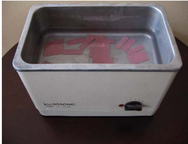
Resim 5: Ultrasonik temizleyicideki akrilik örnekler.
