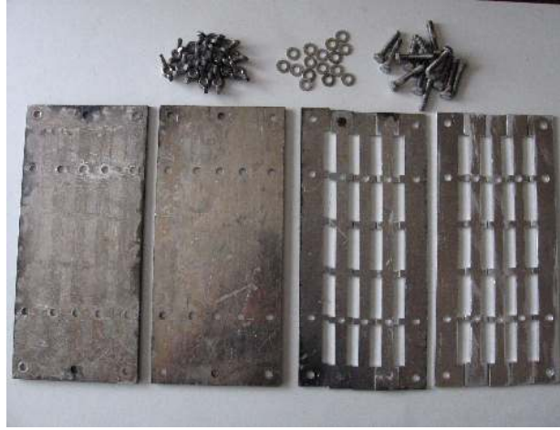
Resim 3: PMMA örneklerin hazırlanmasında kullanılan alüminyum kalıplar
