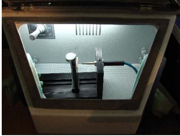
Resim 4: Kumlama işleminin standardizasyonunu sağlayan sabitleyici
