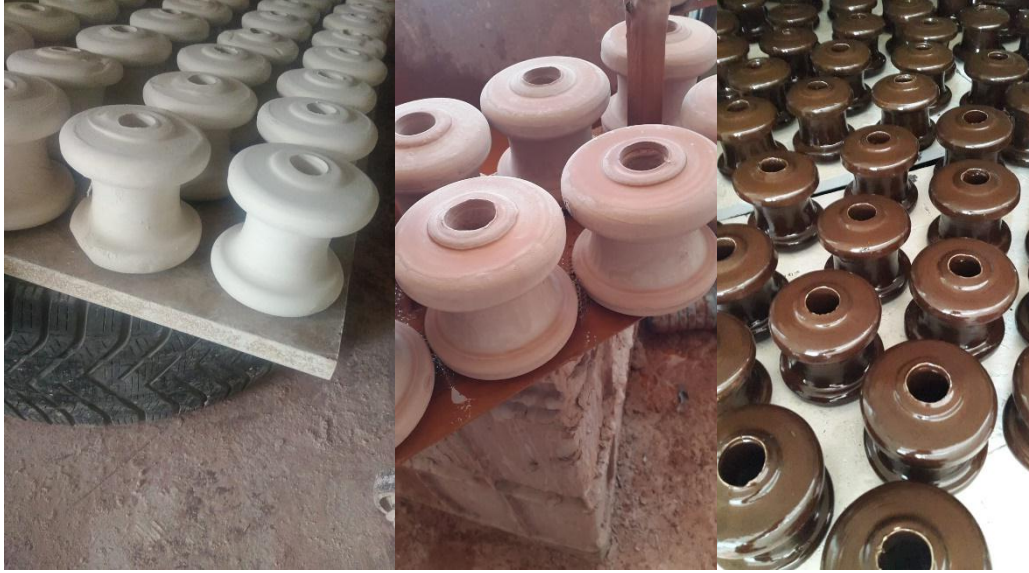
Şekil 3.6. Sırasıyla kurutulmuş, sırlanmış ve pişirilmiş malzeme
