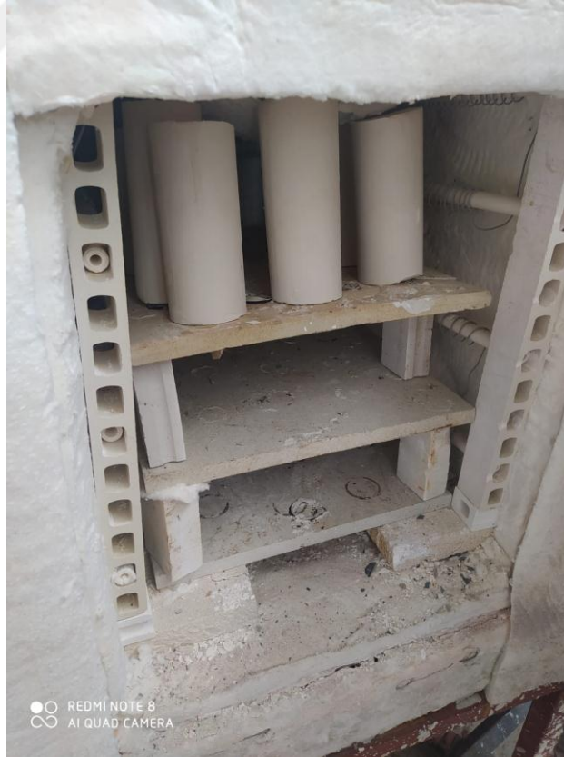
Şekil 3.9. Numune üretimi için kullanılan elektrikli fırın
