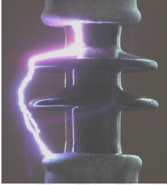
Şekil 4.5. Elektrik atlaması (arc) görülen porselen izolatör
