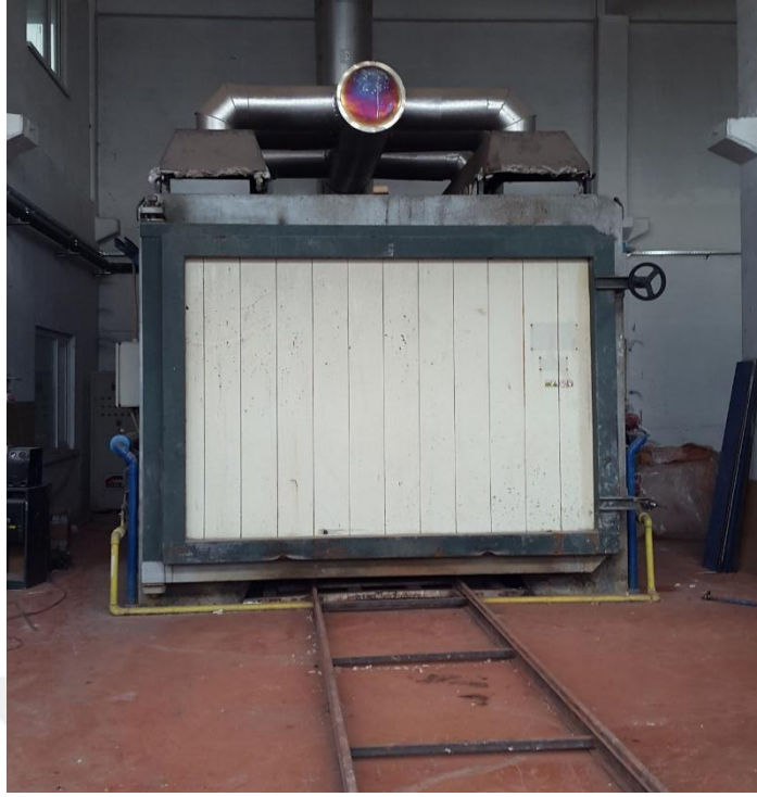
Şekil 3.8. Porselen izolatör üretiminde kullanılan doğalgazlı fırın
