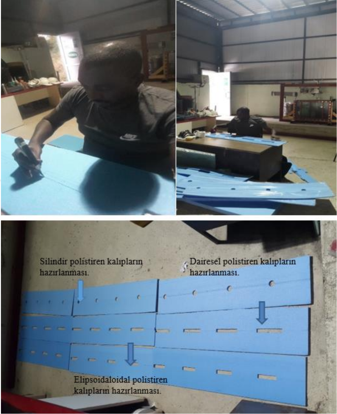
Şekil 3.15. Derzlerde kullanılan polystyrene kalıpların hazırlanması
