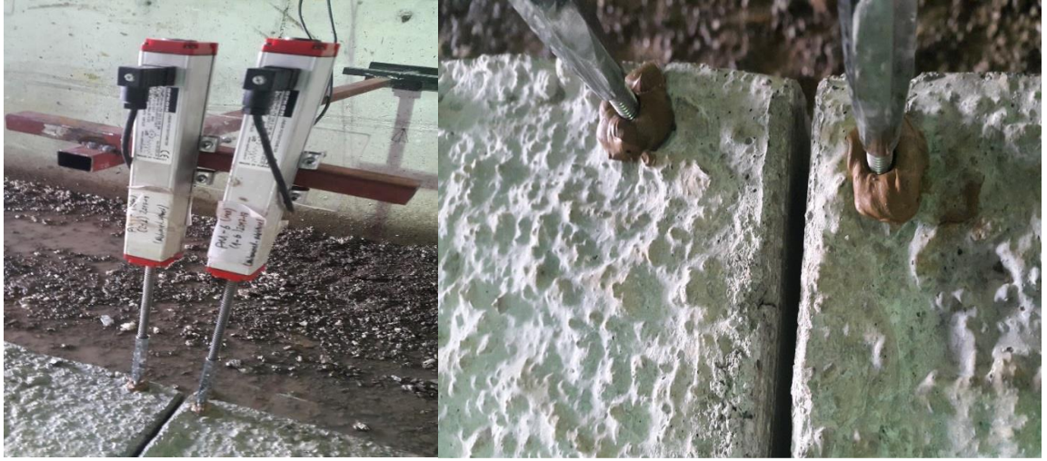
Şekil 3.25. Derzin her iki tarafında yerleştirilen LVDT
