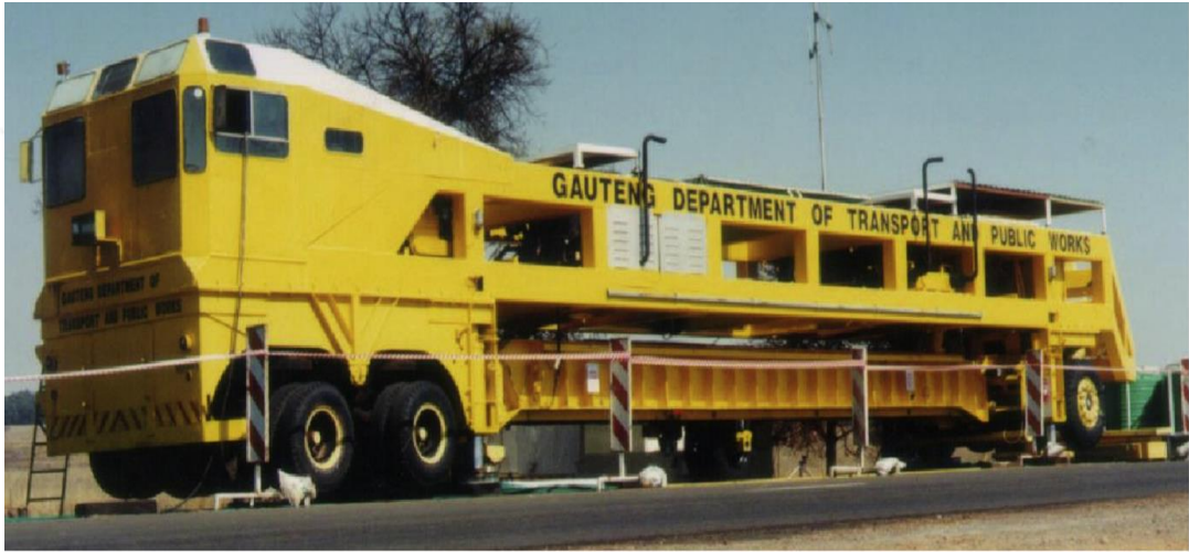
Şekil 2.22. Güney Afrika Hızlandırılmış Yol Testi Mk III [74]
