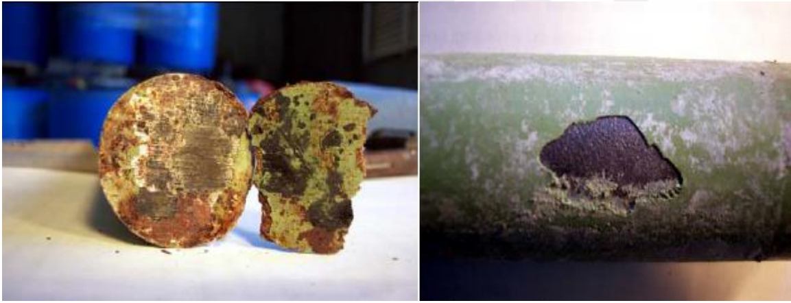
Şekil 2.10. Epoksi kayma donatıları zamanla paslanabilir [52]
