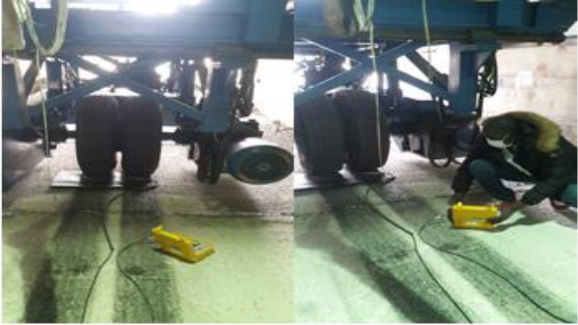
Şekil 3.27. Veri toplama ünitesi ve tekerlek altına yerleştirilen basınç ölçerler
