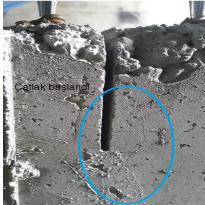
Şekil 4.84. 30.000 yükleme uygulanmasından sonrası çatlak açıklığının gelişimi
