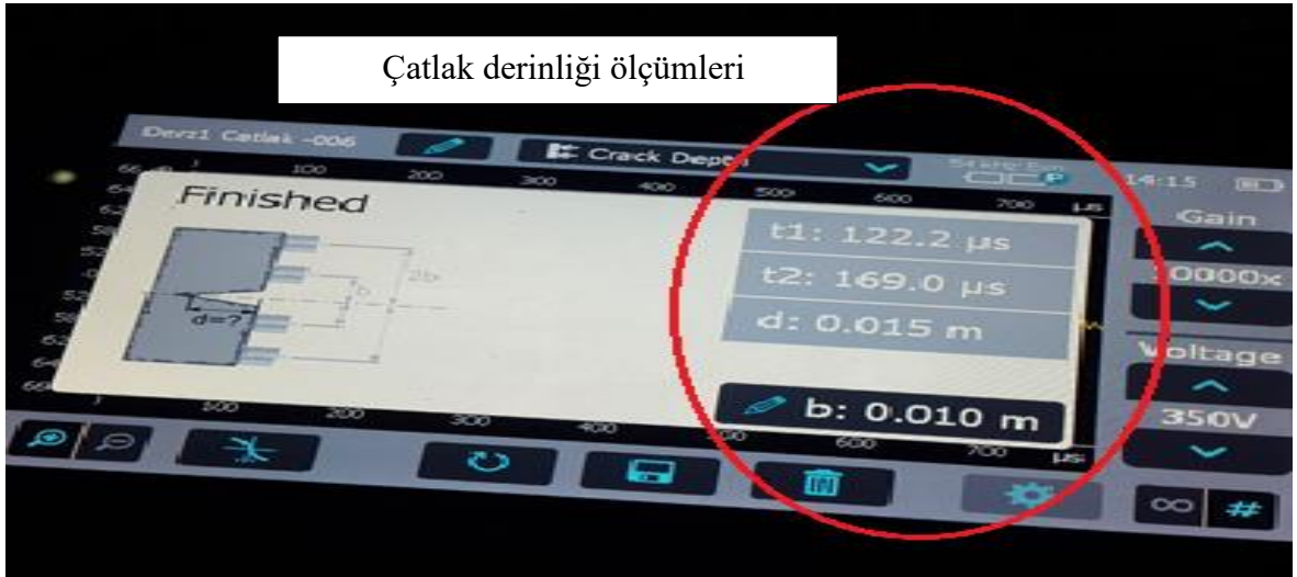
Şekil 4.70. Derz derinliği boyunca çatlak ölçümleri
