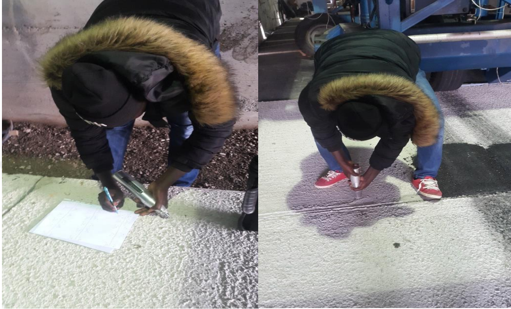
Şekil 3.28. Beton mukavemetinin çekiç cihazıyla ölçülmesi
