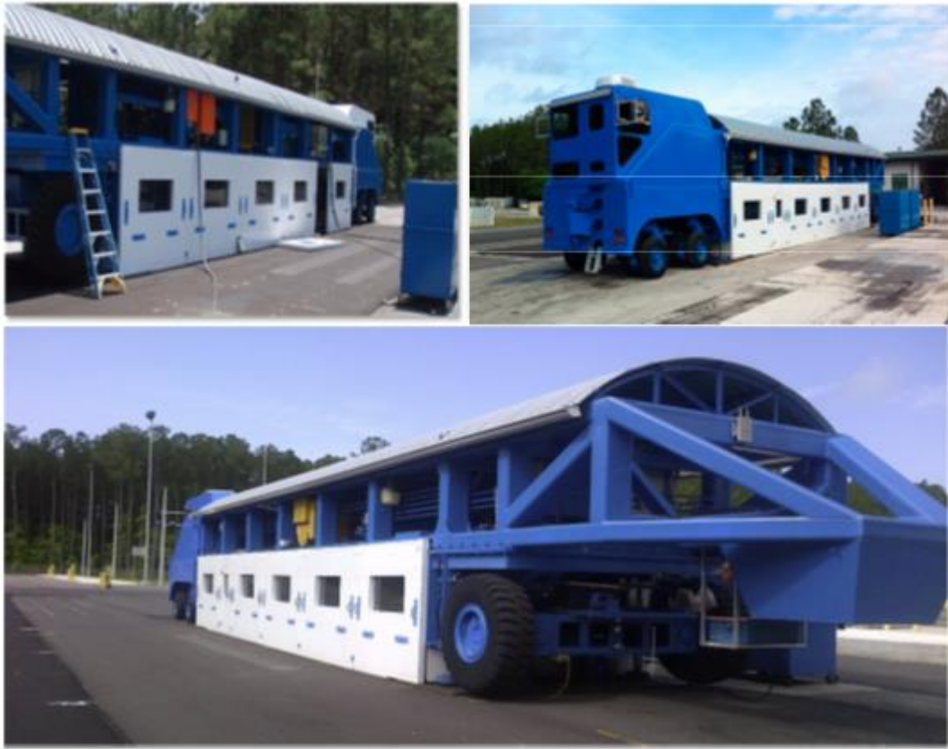
Şekil 2.25. FDOT's Hızlandırılmış Yol Testi [72]
