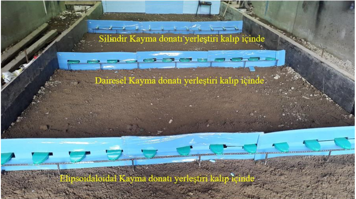
Şekil 3.17. Kayma donatıların beton dökümü öncesi son hali
