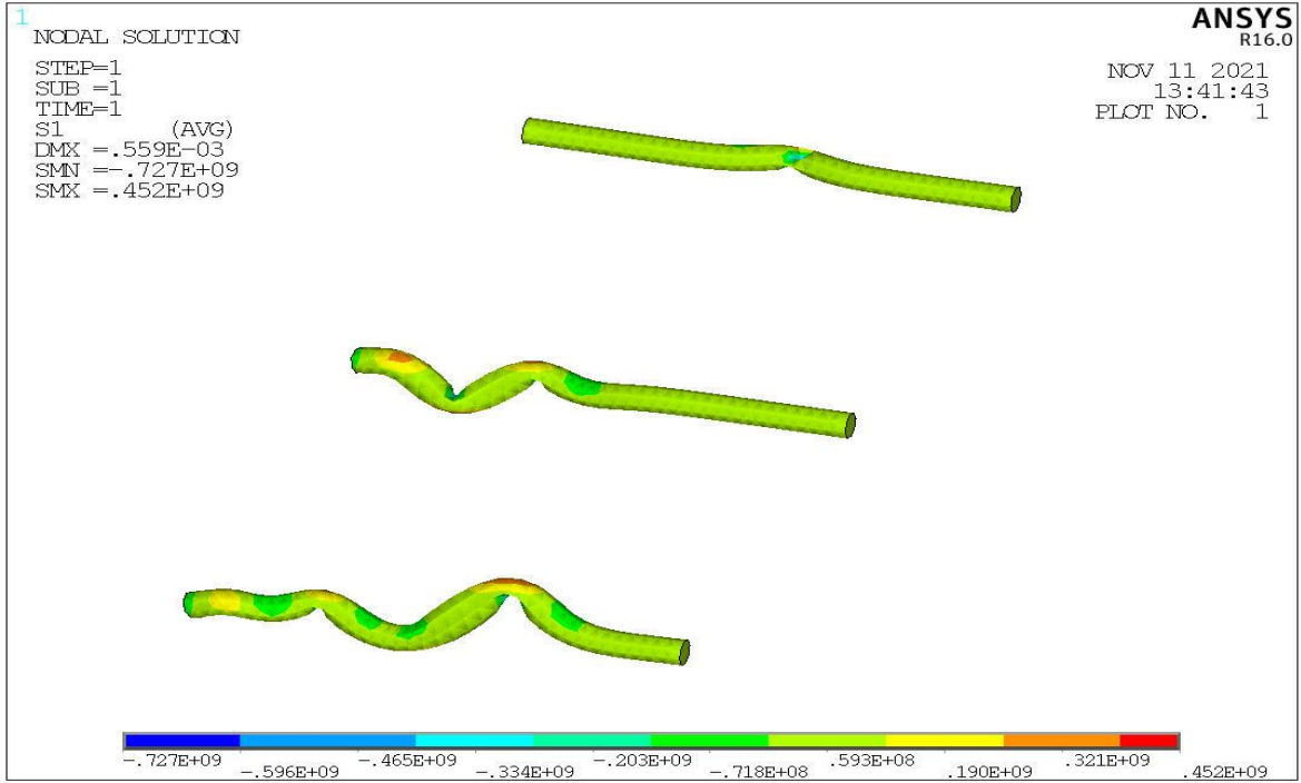
Şekil 4.5. Silindir kayma dontası çap 19.05 mm yüklü olan kısımdaki çekme gerilme sonuçları
