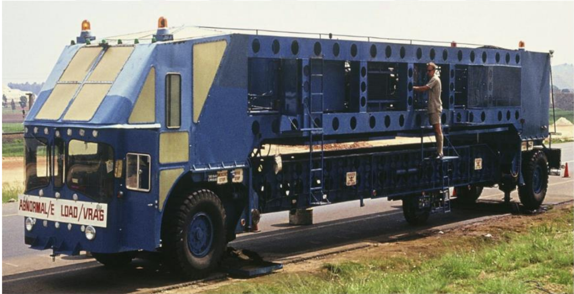
Şekil 2.21. Güney Afrika Hızlandırılmış Yol Testi MKII sistemi [74]
