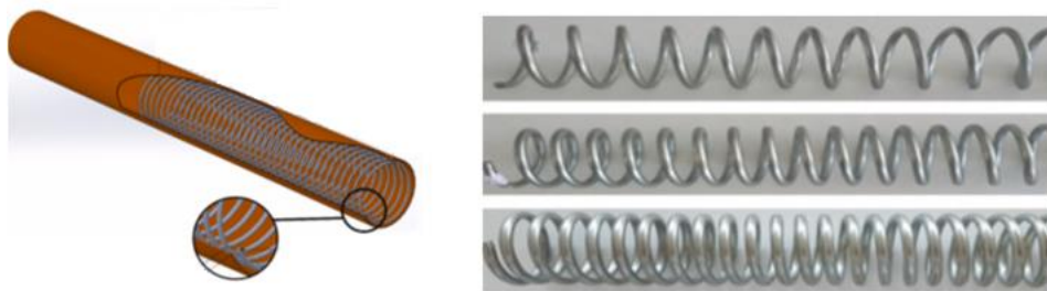
Şekil 1.21. Sargılı tel türbülátör ve eş merkezli çift borulu ısı eşanjöründe yerleşimi (Celik ve ark., 2023)
