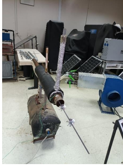
Şekil 3.5. Kanat silindirik tip türbülatorün ısı değıştiricisi iç borusuna yerleřtirilmesi
