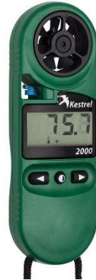
Şekil 3.6. Deneyde kullanılacak dijital anemometre
