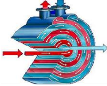
Şekil 1.17. Spiral ısı değıştirciler (şematik gösterim) (Bulgurcu ve ark., 2020)
