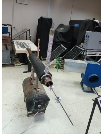
Şekil 3.5. Kanat silindirik tip türbülatorün ısı değıştiricisi iç borusuna yerleştilmesi
