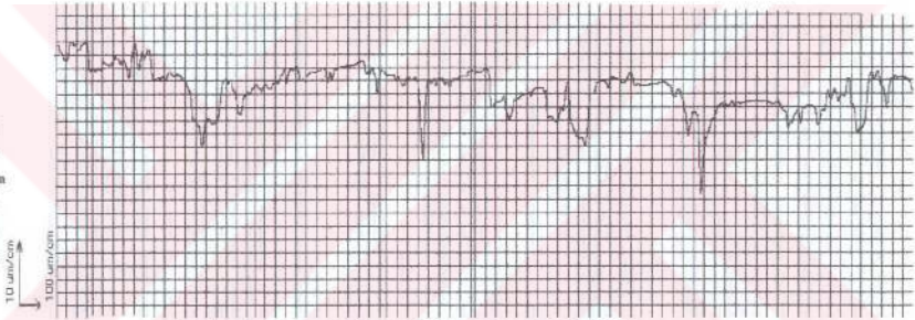
Kullanılmamış ortalama dişli yüzey pürüzlülüğü
