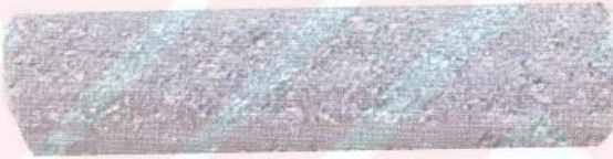
320 Viskoziteyle kullanılmış (P3-Ç3) dişli yüzeyi
