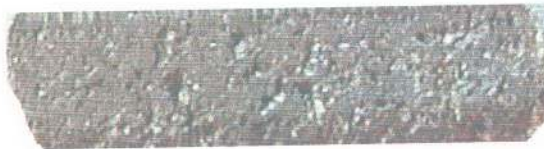
68 Viskoziteyle kullanılmış (P1-Ç1) dişli yüzeyi
