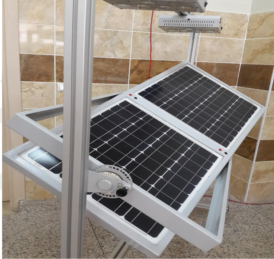
Şekil 3.2. Fotovoltaik modülün alt çerçevesi ve açı ayarlama mekanizması
