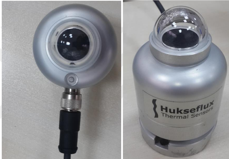
Şekil 3.22. Deney düzeneğinde kullandığımız solar piranometre cihazı
