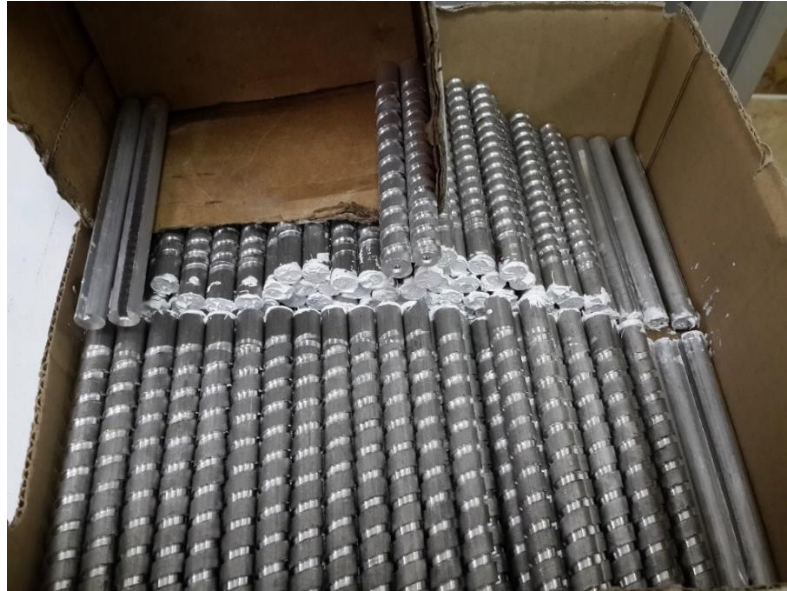
Şekil 3.10. Farklı yüzey alanlarına sahip alüminyum kanatçıklar
