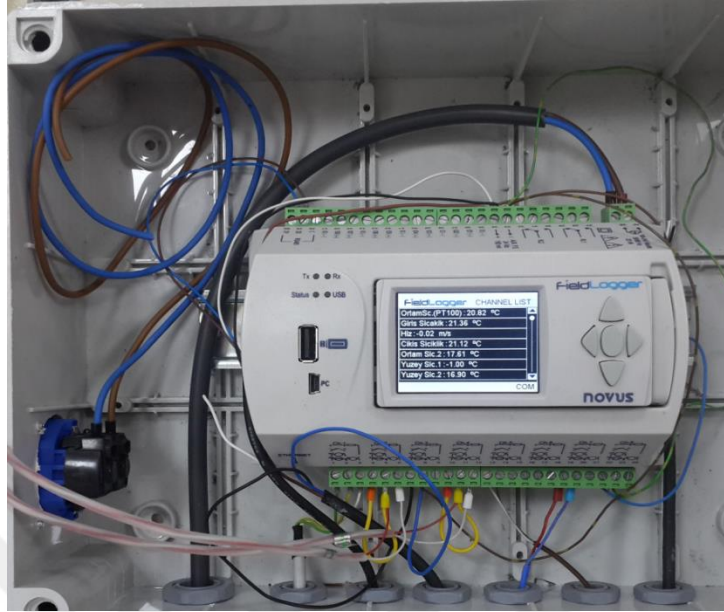
Şekil 3.17. Deney sistemimizde kullanılan veri kaydedici
