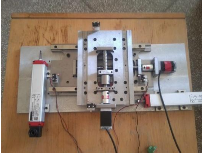
Resim 8.2. X eksenindeki sistemin montajı
