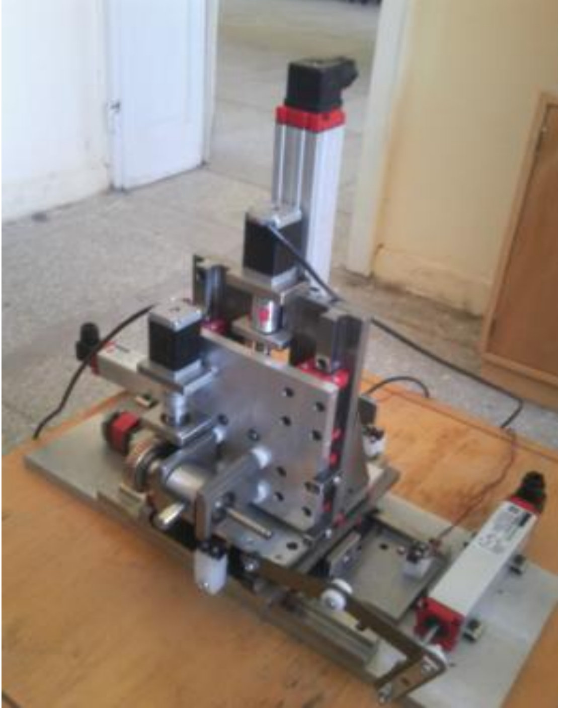
Resim8.5. Açısal hareket sisteminin montajı
