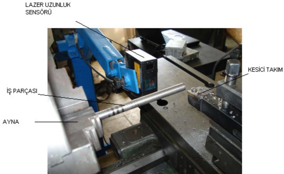
Resim 3.7 Bir ucundan bağlı iş parçası deney düzeneği
