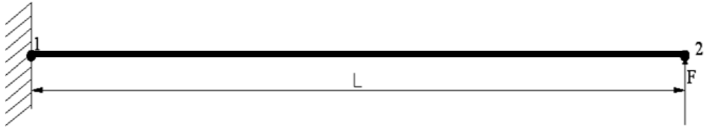
Şekil 4.14 Bir ucundan bağlı iş parçası için sonlu elemanlar modeli
