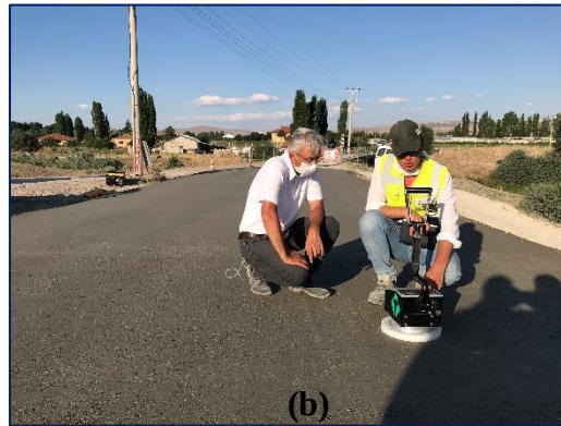
Resim 5.7. Sıkışma kontrol ölçümleri (a) Kum konisi testi (b) Elektromanyetik test
