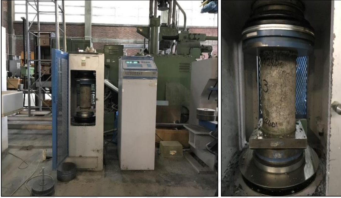
Resim 4.8. Basınç dayanımı test cihazı ve bir numunenin yükleme sırasındaki fotoğrafı
