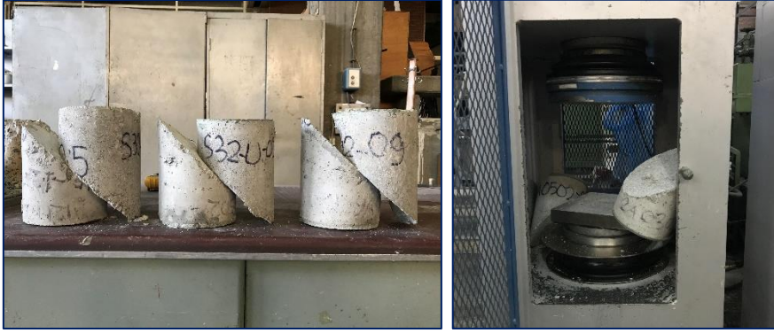
Resim 4.17. Epoksi reçine [E] ara yüzeyli numunelerin eğimli kesme deneyi sonrası fotoğrafları
