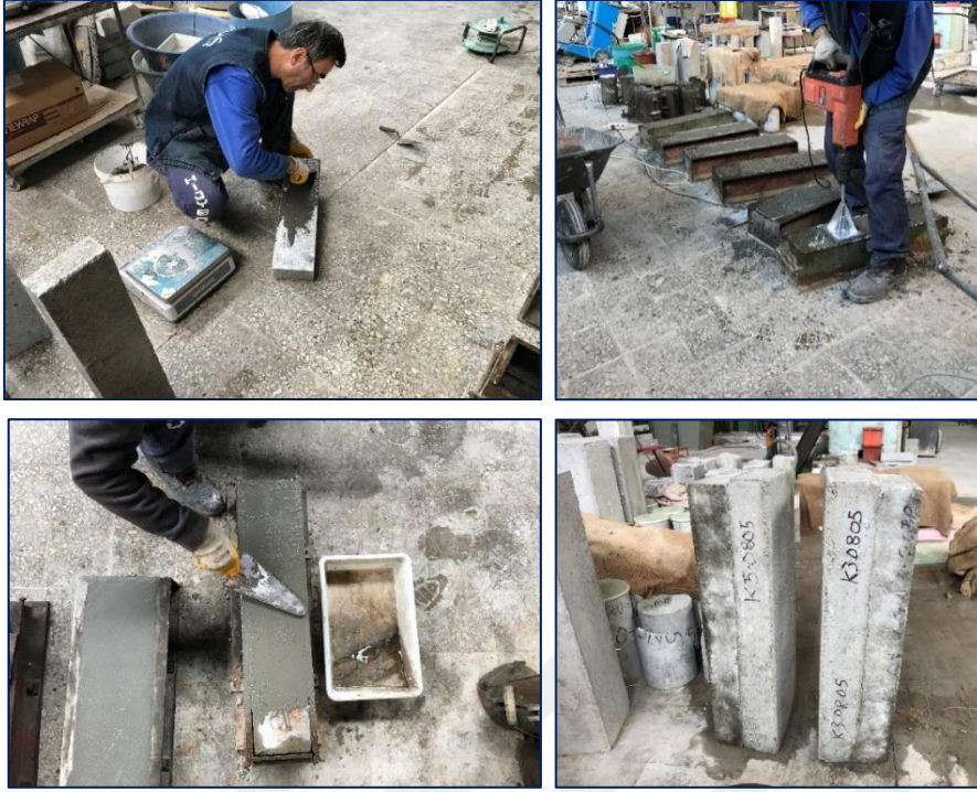
Resim 4.24. Ara yüzey elemanı ve kiriş üst yüzeylerinin düzenlenmesi
