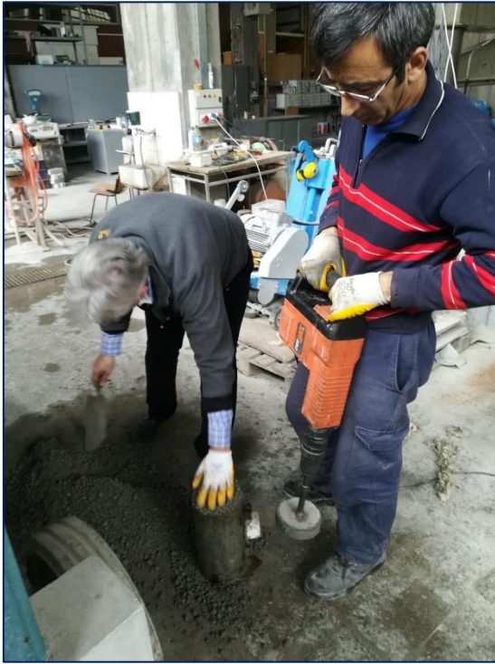
Resim 4.4. SSB numunelerinin titreşimli tokmak ile sıkıştırılması (ASTM C1435M-20, 2020)
