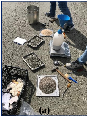
Resim 5.7. Sıkışma kontrol ölçümleri (a) Kum konisi testi (b) Elektromanyetik test
