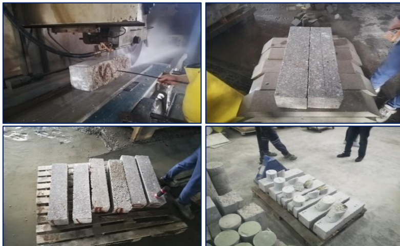
Resim 5.14. Kiriş numunelerinin deney için hazırlanması
