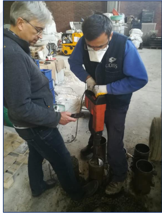
Resim 4.4. SSB numunelerinin titreşimli tokmak ile sıkıştırılması (ASTM C1435M-20, 2020)
