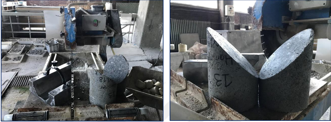
Resim 4.14. Numunelerin kesme makinesi ile 45° lik 2 eşit parçaya bölünmesi
