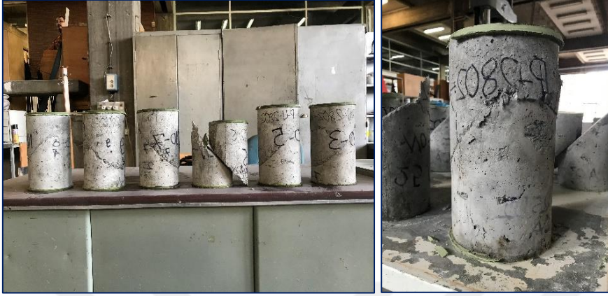
Resim 4.20. Pürüzlü yüzey [P] ara yüzeyli numunelerin eğimli kesme deneyi sonrası fotoğrafları
