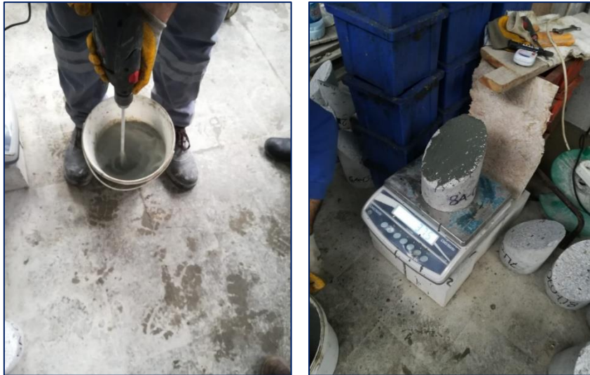
Resim 4.9. Lateks hazırlanması ve ara yüzey uygulama aşamaları
