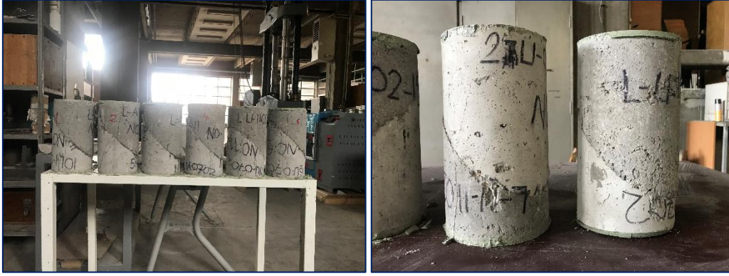
Resim 4.16. Lateks [L] ara yüzeyli numunelerin eğimli kesme deneyi sonrası fotoğrafları
