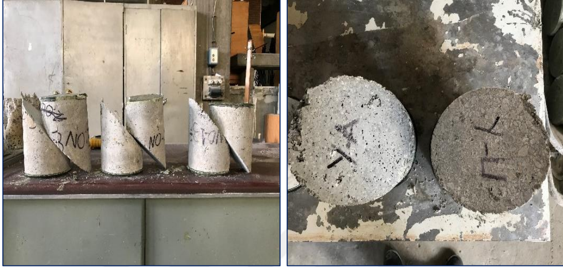
Resim 4.21. Ara yüzey elemanı [Y] numunelerin eğimli kesme deneyi sonrası fotoğrafları
