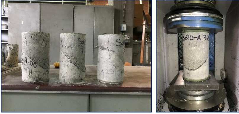
Resim 4.18. Aderans harcı [A] ara yüzeyli numunelerin eğimli kesme deneyi sonrası fotoğrafları
