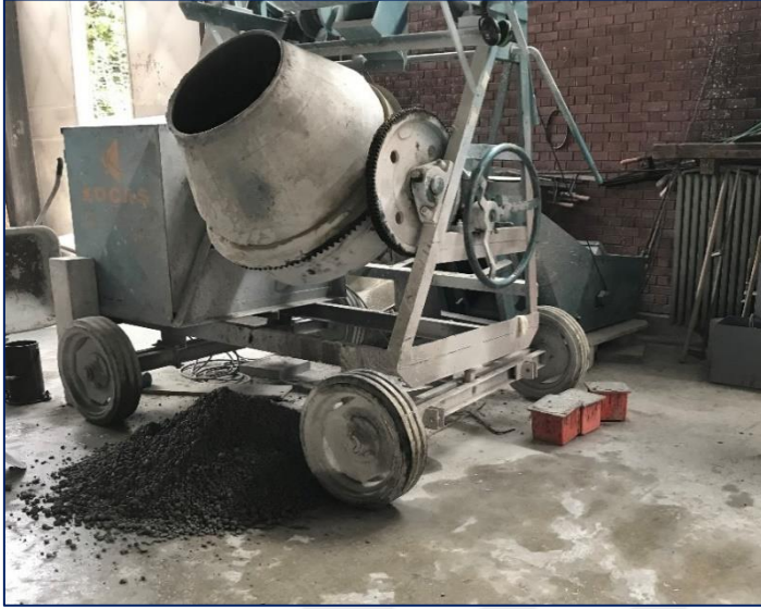
Resim 4.2. SSB karışımın tamburlu karıştırıcıda hazırlanması
