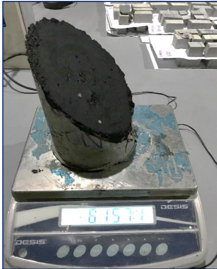
Resim 4.12. Bitümlü yapıştırıcı ile ara yüzey uygulaması
