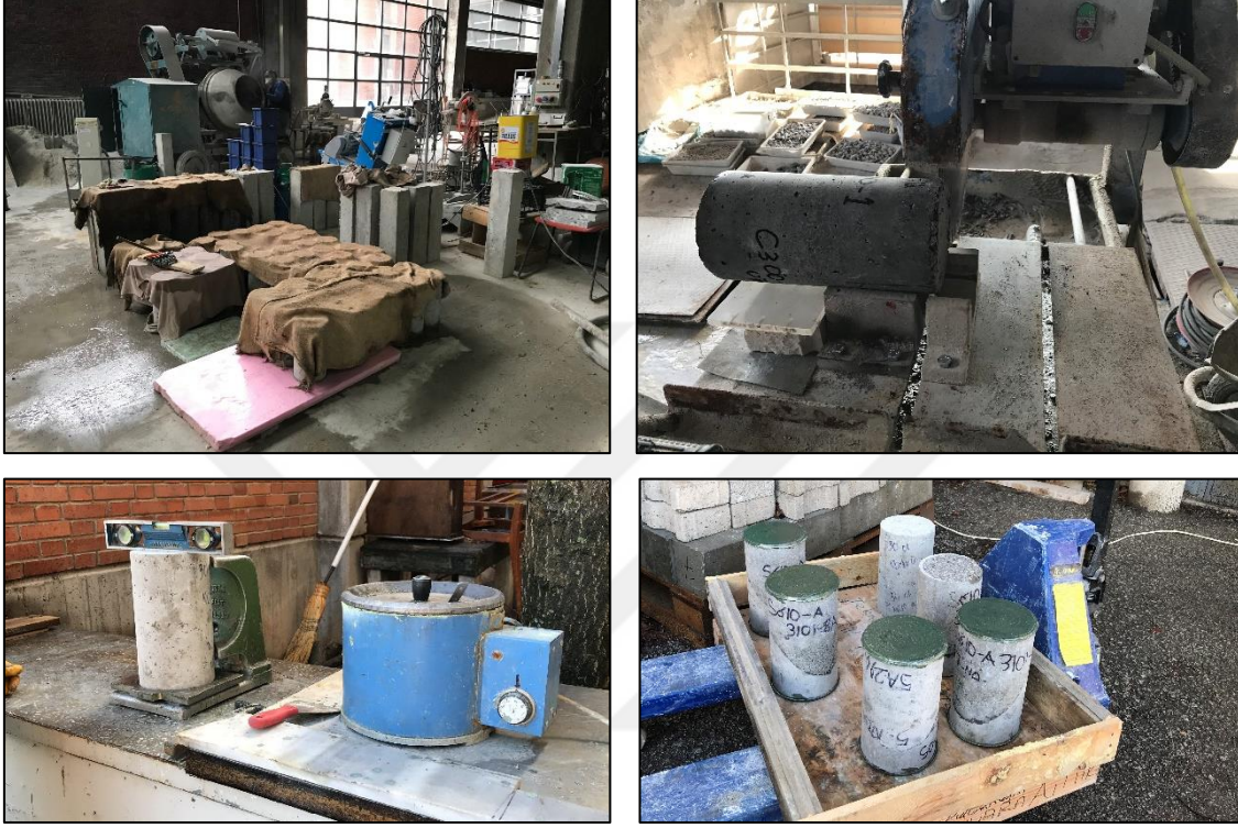
Resim 4.7. Bazı numunelerin kür, kesim ve kükürt başlık aşamaları
