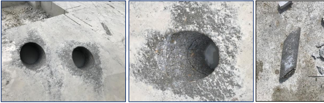
Resim 5.10. Aderans harçlı iki tabaka SSB karot alım aşamaları
