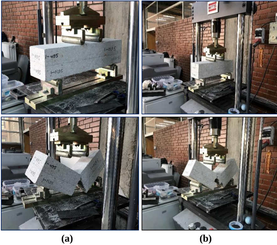
Resim 5.16. Aderans harçlı iki tabaka SSB numuneleri kiriş eğilme deneyleri (a) A-K1 numunesi (b) A-K2 numunesi
