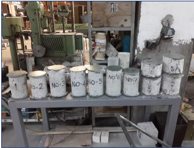
Resim 5.11. Basınç dayanımı deneyi için hazırlanan karot numuneleri
