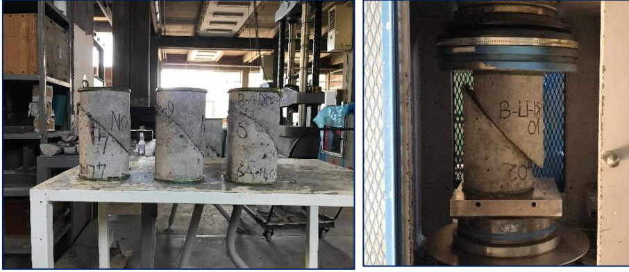
Resim 4.19. Bitümlü yapıştırıcı [B] ara yüzeyli numunelerin eğimli kesme deneyi sonrası fotoğrafları
