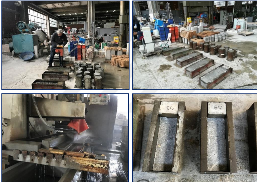
Resim 4.23. Kiriş numunelerinin hazırlanması
