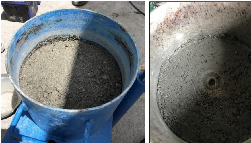
Resim 4.6. Vebe deneyi kısmi harç halkası oluşumu
