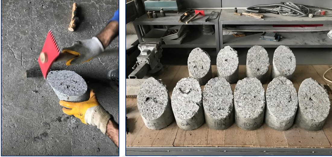
Resim 4.13. İki tabaka ara yüzeyinde pürüzlendirme işlemi
