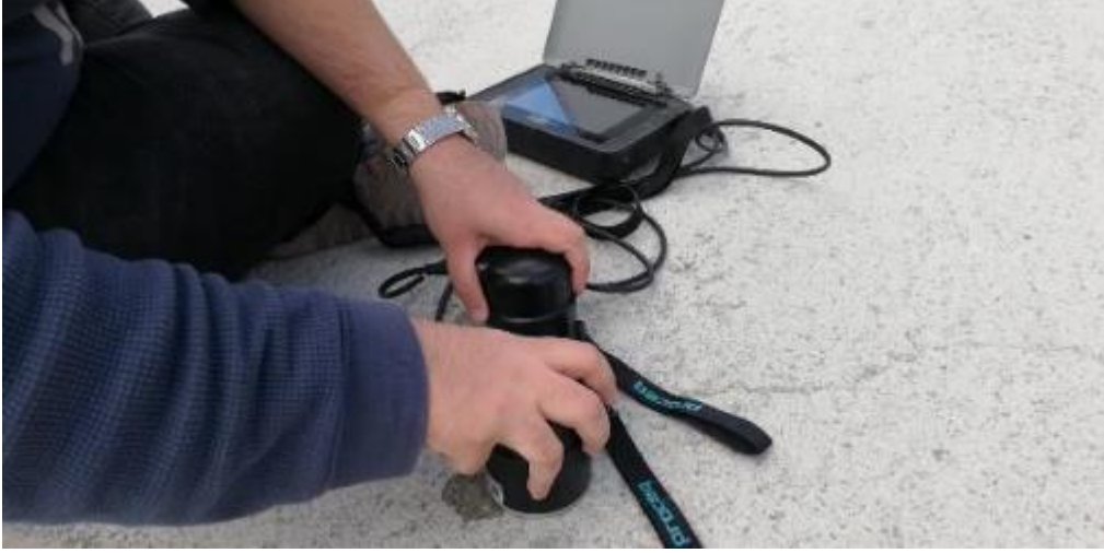
Şekil 39. Boyuna derz üzerinde ölçüm alınması
