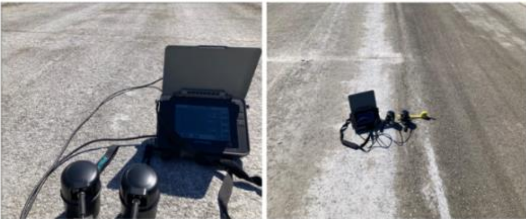
Şekil 41. Çalışma sahasında boyuna derz yakını ölçümlerinin yapılması
