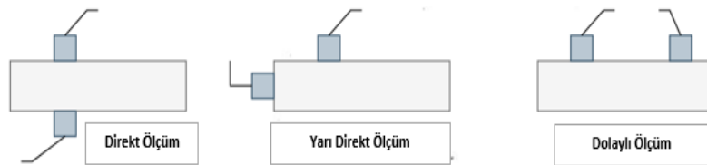
Şekil 19. Ölçüm yöntemleri ve ilgili prob düzenleri
