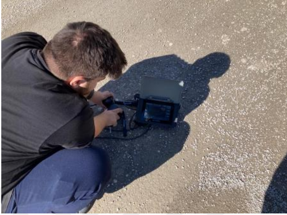
Şekil 42. Çalışma sahasında kaplama ortasından basınç dayanım ölçümlerinin alınması
