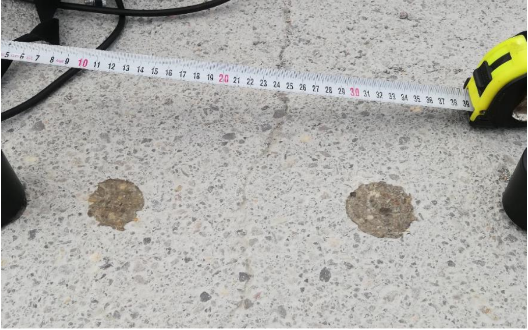
Şekil 37. Ölçüm öncesinde temizlenmiş ve prob temas yüzeyleri jel ile kaplanmış temas noktaları
