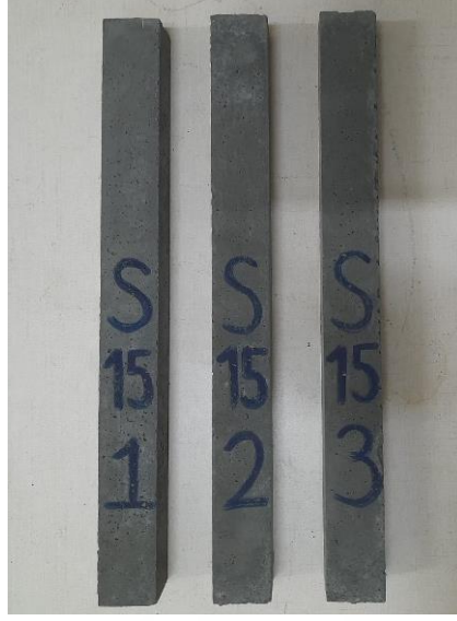
Şekil 22. Kalıplarından çıkarılan ve numaralanan harç numuneler
