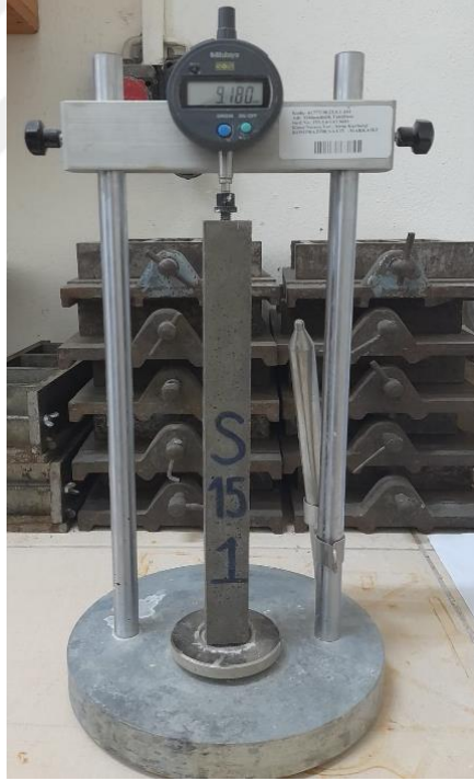
Şekil 23. Boy ölçümleri için kullanılan aparat
