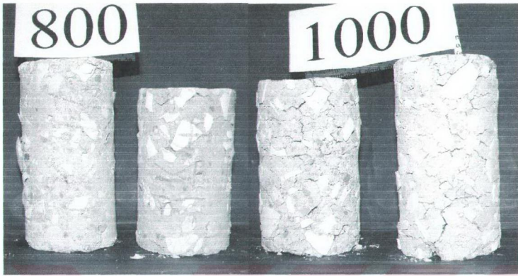
Resim 4.1. 1100 kodlu numunelerin, 800 ve 1000°C sıcaklık uygulanmasından sonraki durumları
