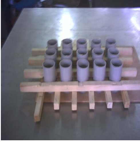
Resim 3.1. Betonarme numune üretimi için hazırlanan kalıp düzeneği
