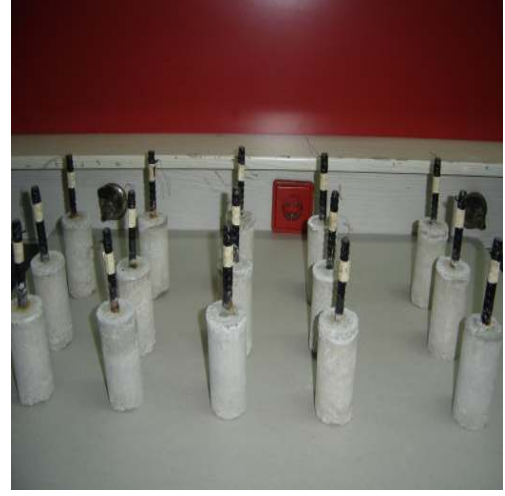
Resim 3.2. Üretilen betonarme numuneler
