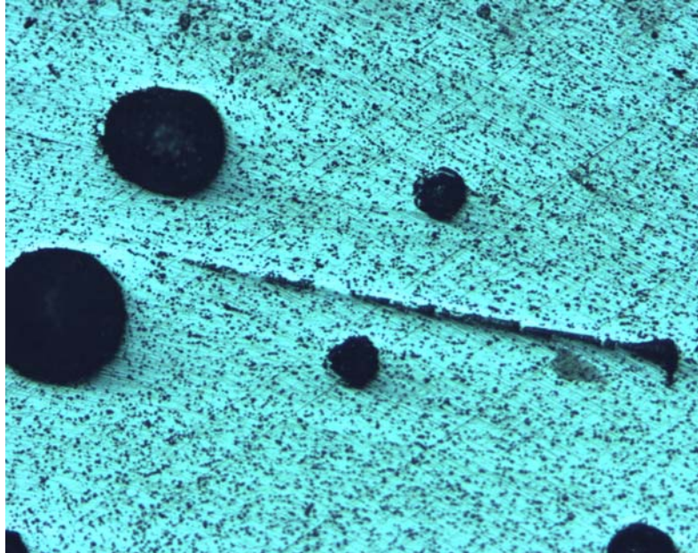
Şekil 8.40 250 Rpm hızla ve 5 Dakika karıştırılarak 1000 °C’de dökülmüş, oksitlenmiş SiC takviyeli AMK numune boyuna kesit merkez bölgesi (50X) büyütme
