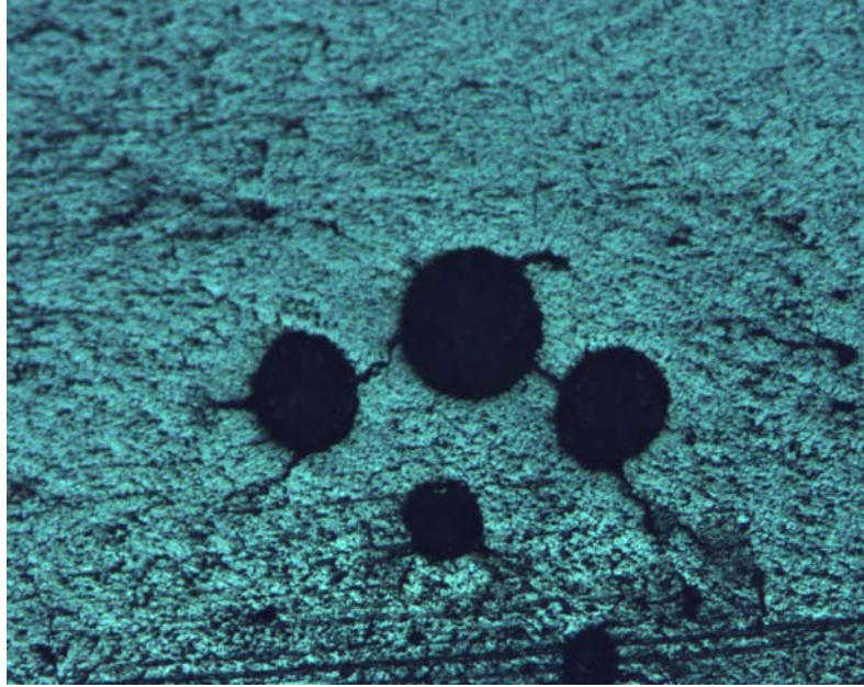
Şekil 8.34 250 Rpm hızla ve 5 Dakika karıştırılarak 1000 °C’de dökülmüş, oksitlenmiş SiC takviyeli AMK numune boyuna kesit kenar bölgesi (50X) büyütme
