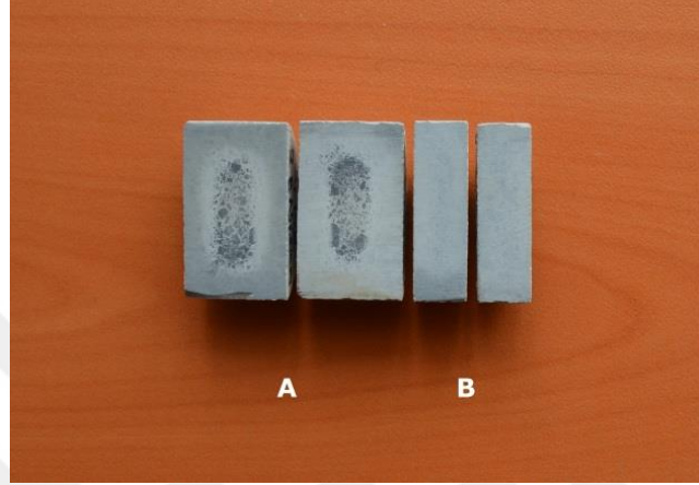
Şekil 4.18. Y/Sm oksit ilaveli numunelerin 1370°C'de 2 saat ve 1420°C'de 2 saat süreli nitrürleme işlemleri sonrası kesit görüntüleri.
