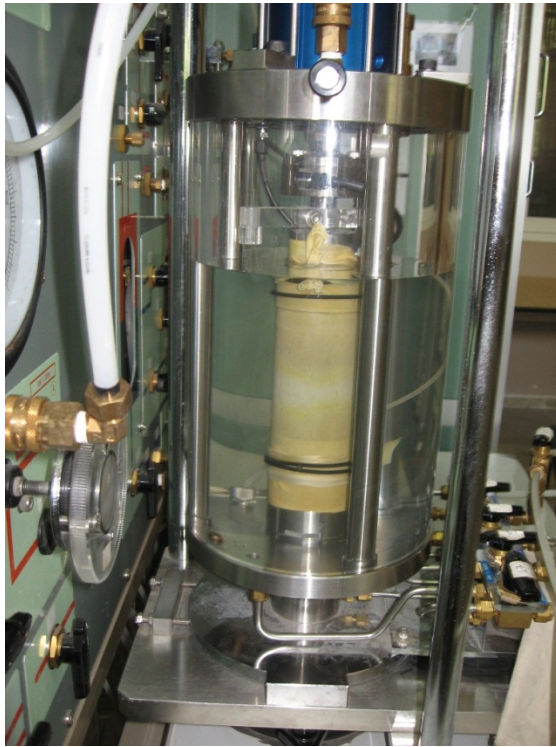
Şekil 3.13 Örneğin içinden CO 2 geçirilmesi
