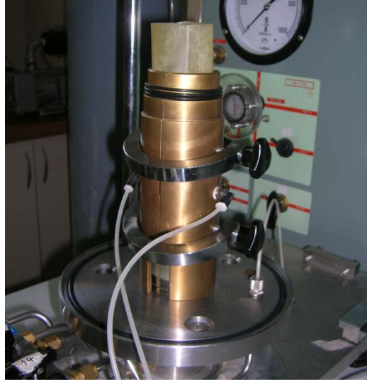
Şekil 3.11 Deney sisteminde kullanılan membran ve mold yerleşimi
