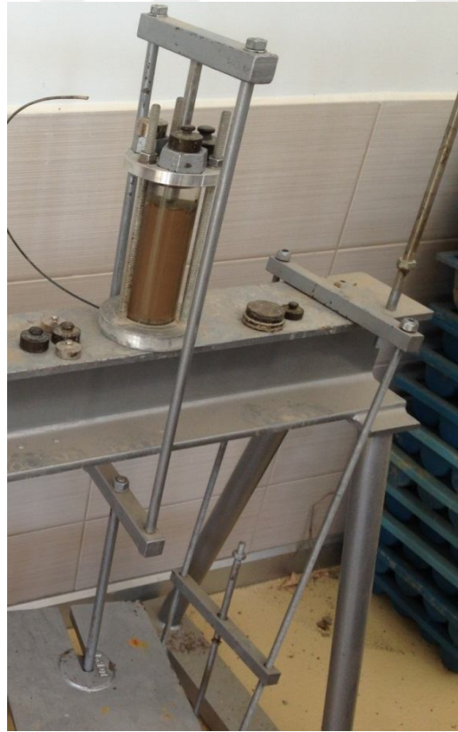
Şekil 5.15. Numunelerin bulamaçtan 100 kPa düşey gerilme altında yeniden oluşturulması
