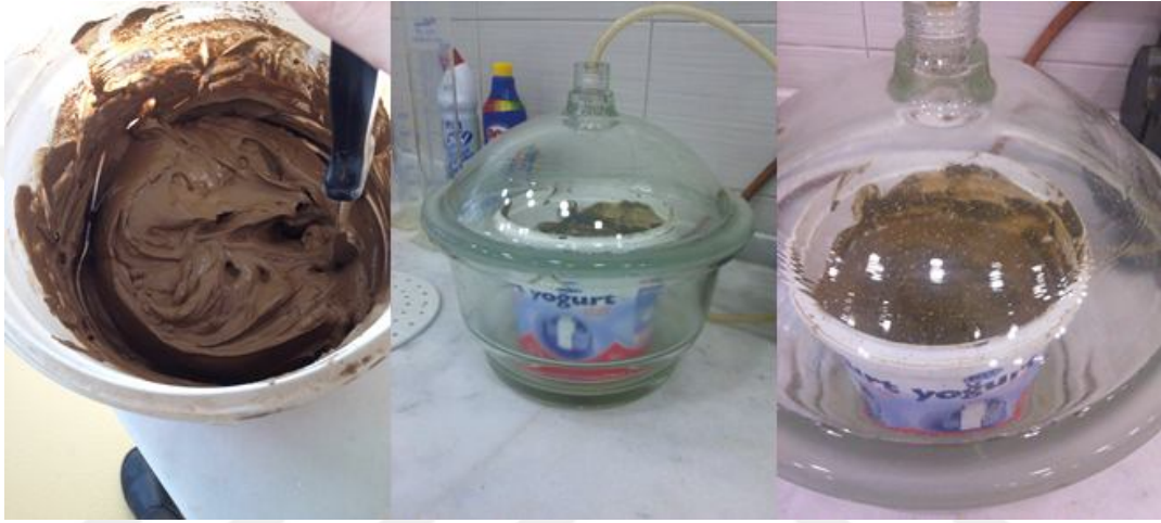
Şekil 5.13. Su ilave edilip hazırlanan numuneye vakum uygulama
