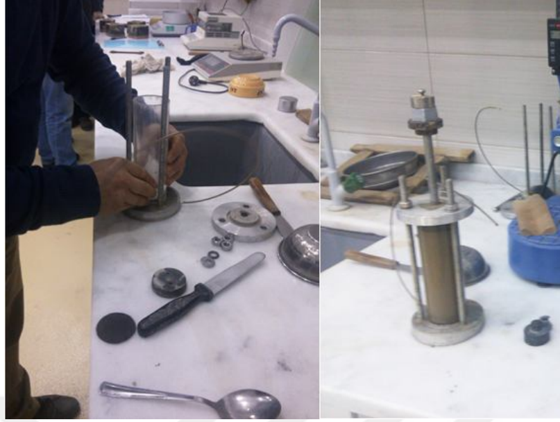
Şekil 5.14. Vakum uygulanan numunelerin 5 cm çaplı hücelere yerleştirilmesi
