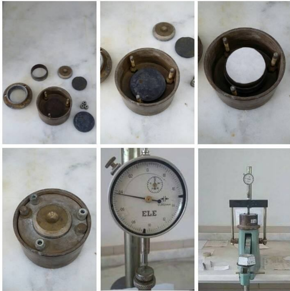
Şekil 5.19. Konsolidasyon hücresinin hazırlanması ve deneye başlanması
