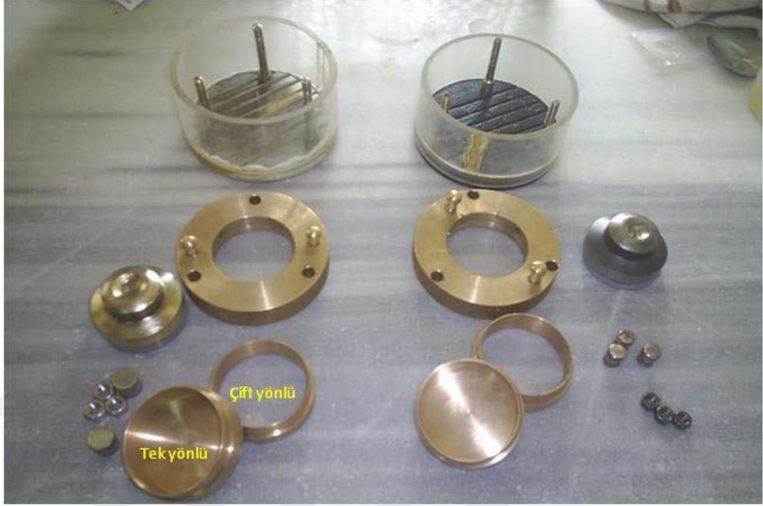
Şekil 4.2. Tek ve çift yönlü konsolidasyon hücresi [23]
