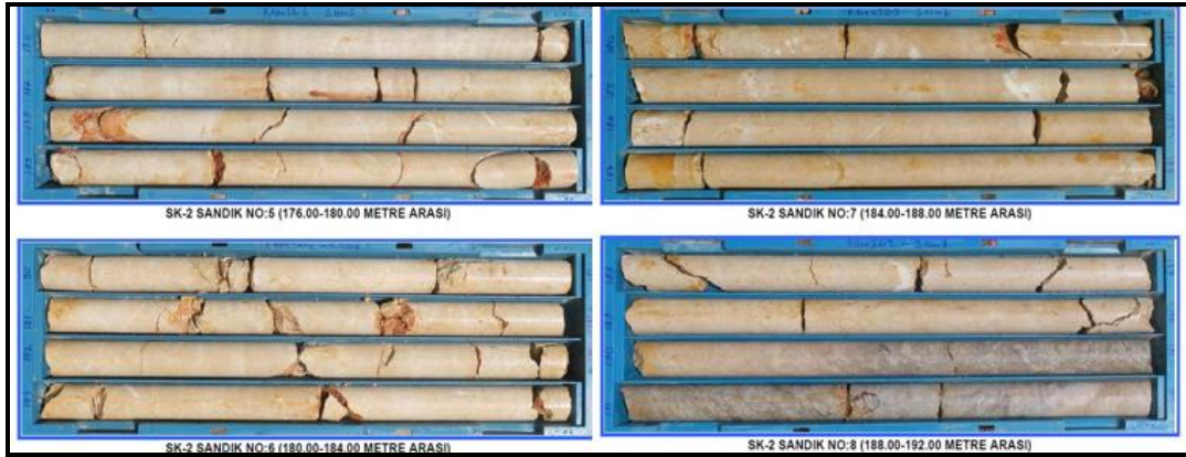
Şekil 4.9. SK-2 kuyusuna ait karot sandıkları (DSİ,2017)
