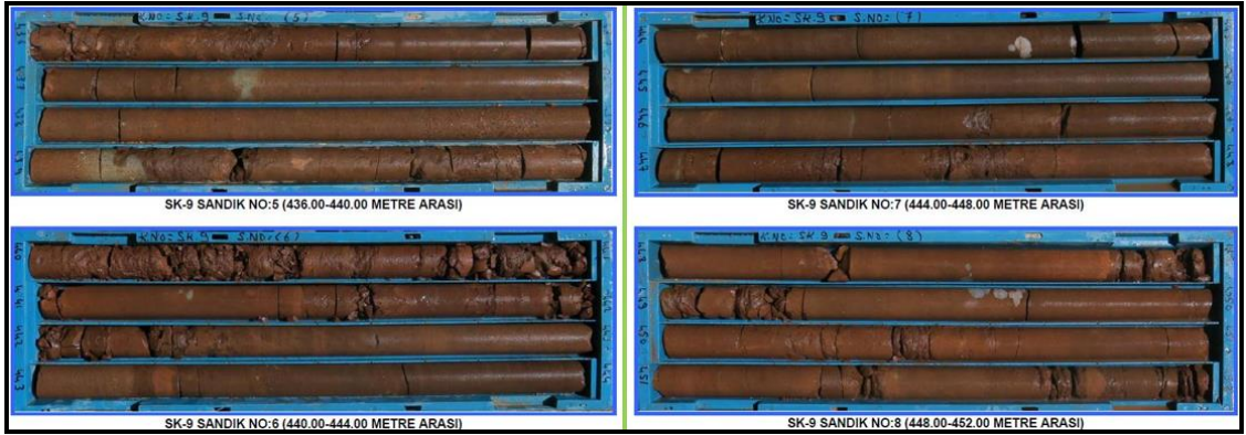
Şekil 4.38. SK-9 kuyusuna ait karot sandıkları (DSİ,2017)
