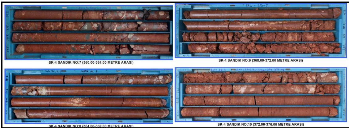
Şekil 4.17. SK-4 kuyusuna ait karot sandıkları (DSİ,2017)
