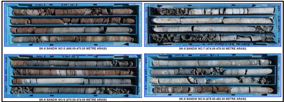
Şekil 4.25. SK-6 kuyusuna ait karot sandıkları (DSİ,2017)
