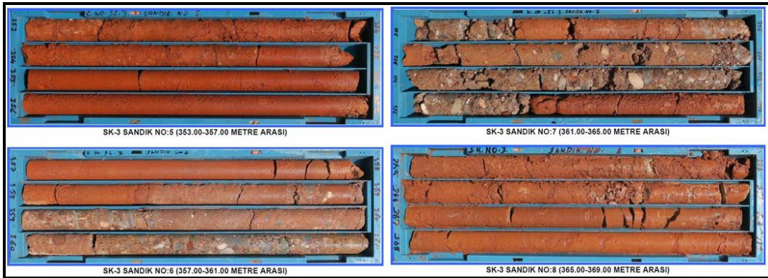
Şekil 4.13. SK-3 kuyusuna ait karot sandıkları (DSİ,2017)
