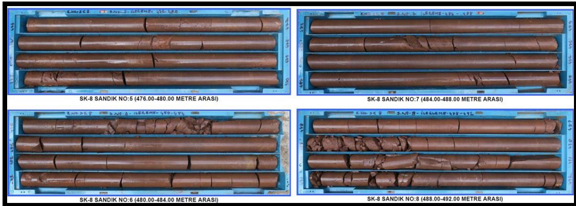
Şekil 4.34. SK-8 kuyusuna ait karot sandıkları (DSİ,2017)
