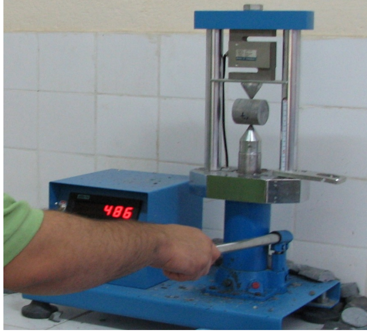
Şekil 4.27. Silttaşlarında nokta yükü dayanım indeksinin belirlenmesi
