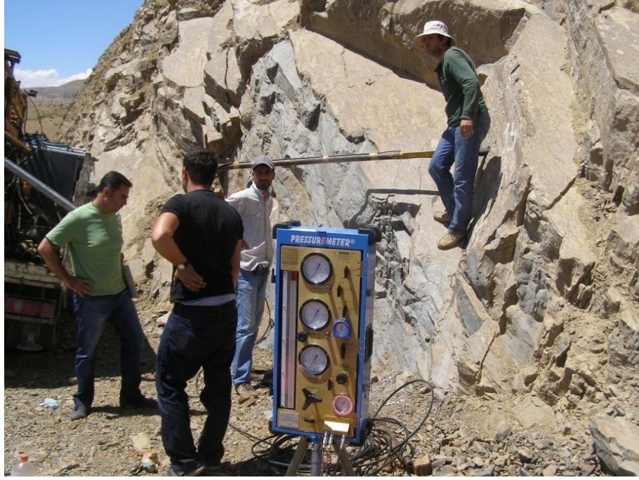
Şekil 4.20. Arazide Menard GA tipi presiometre deney aleti ile deneyin yapılışı.
