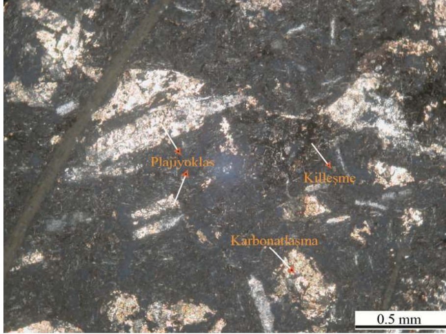
Şekil 3.7. Maden Karmaşığı'na ait bazaltlardaki mikrolitik porfirik dokunun çift nikoldeki mikroskop görünümü.
