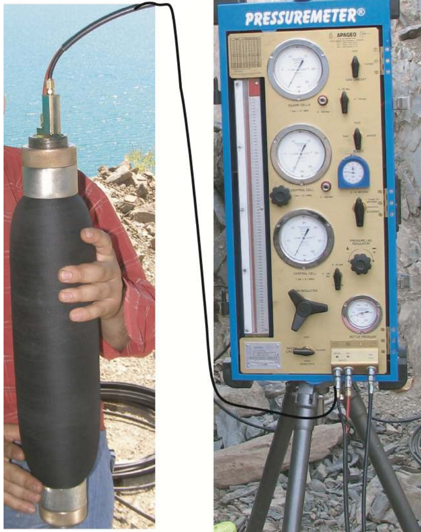
Şekil 4.15. Presiyometre için açık havada basınç kalibrasyonu deney düzeneği.
