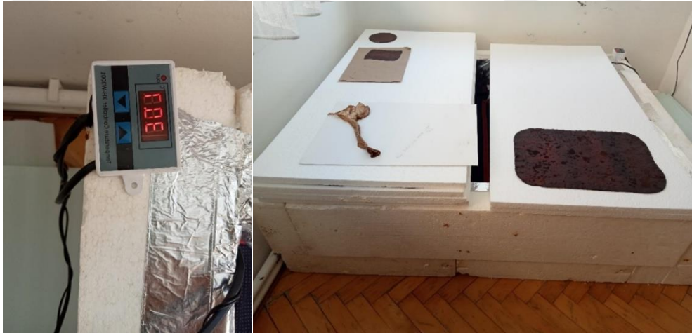
Görsel 5.36. Yetiştirme alanı olarak tasarlanan strafor kabin ve termostatlý sistem
