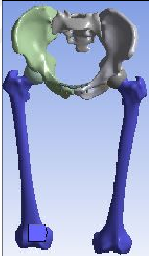
řekil 3.13 Boyutu 6 mm olan elemanlar ile mesh oluřturulan bölge
