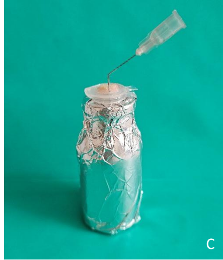
Şekil 3.8. Deney düzeneği, (A) Dişlerin eppendorf tüpü kapaklarına yerleştirilmesi, (B) 27 G iğnenin yerleştirilmesi, (C) Deney düzeneğinin son hali
