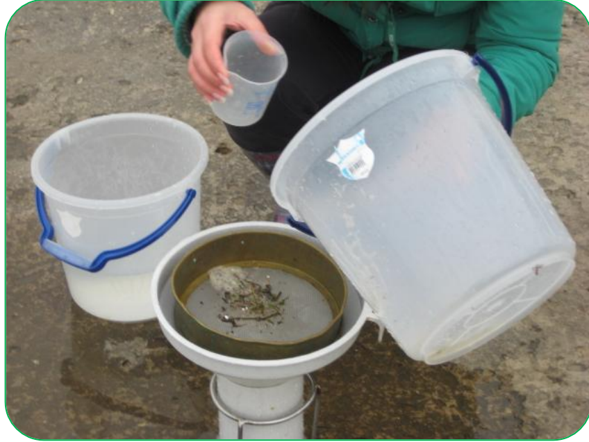
Şekil. 4.1.6.1. Örneklemede kullanılan elek sistemi
