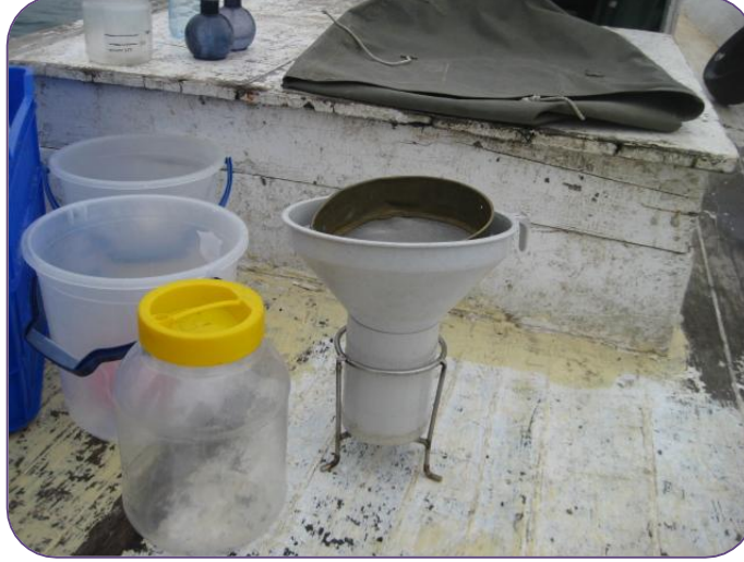
Şekil 4.2.1.1. Örneklemeden hemen sonra örneklerin kavanozlara aktarımında yararlanılan elek düzeneği
