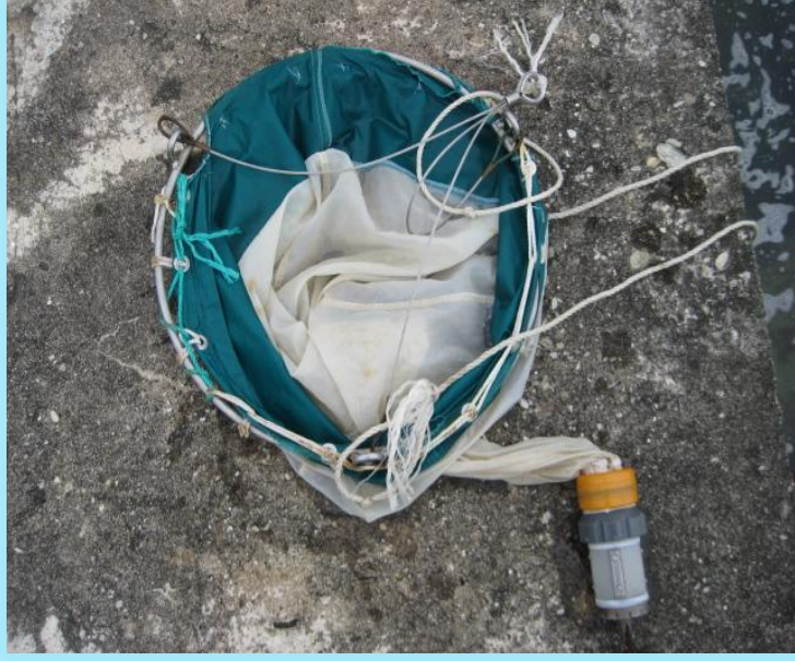
Şekil. 4.1.5.1.2. Standart tip plankton kepçesi (50 cm ağız ve 100 \mu göz açıklığı)
