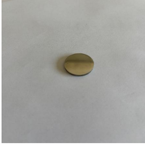
Şekil 3.10 Zımpara ve parlatma işlemi yapılmış numune
