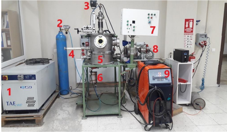
Şekil 3.3 Vakum ark ocağı ünitesi (1; Soğutma ünitesi, 2; Argon gazı, 3; X ve Y eksenlerinde hareketi sağlayan körük, 4; Manipülatör kol, 5; Ark ocağı haznesi, 6; Pnömatrik emiş vanası, 7; Kontrol panosu, 8; Rotary vakum pompası ve turbo moleküler pompa, 9; Ark güç kaynağı).
