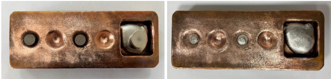
Şekil 3.4 Vakum ark ocağında ergitme öncesi ve sonrası master alaşım numunesi.
