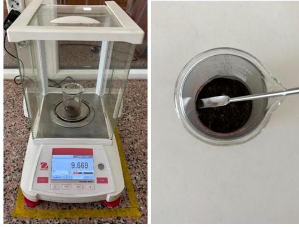
Şekil 3.1 Hassas terazi yardımı ile 100 gr. tartılan toz karışımı.
