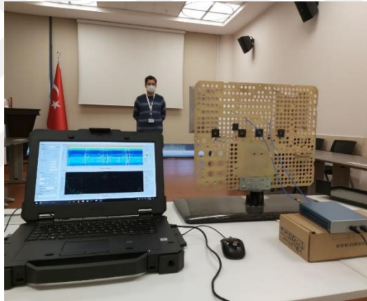
Şekil 5.24 FMCW Radar Hedef Tespiti Deneyleri (Hedef 5 Metrede)
