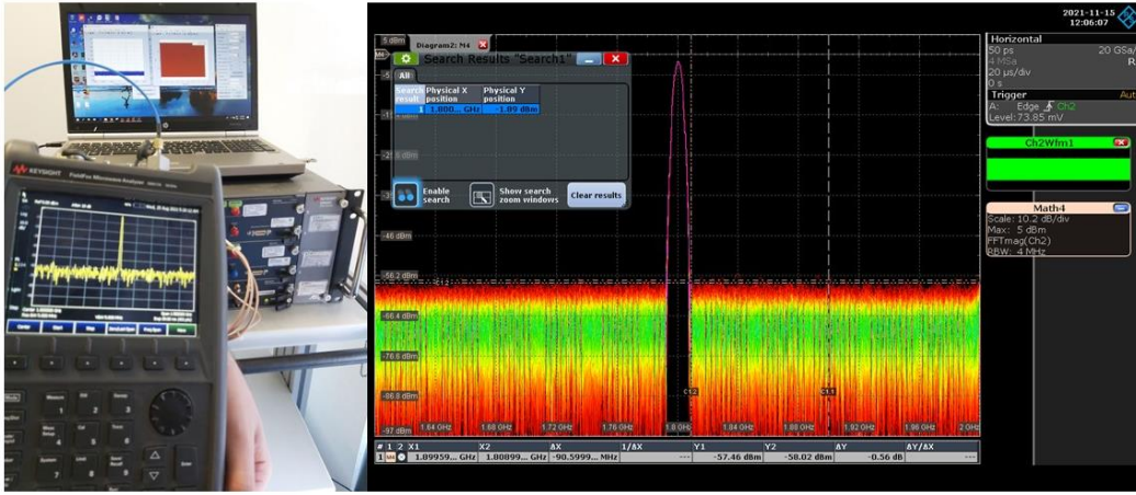
Şekil 4.9 a) Nokta Köreltme Sinyalinin Oluşturulması b) Sinyalin Ölçüm Sonucu
