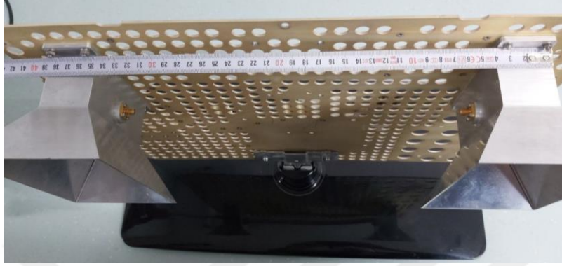
Şekil 5.5 Test Antenleri Arası Mesafe (İki Antenli Yapı)
