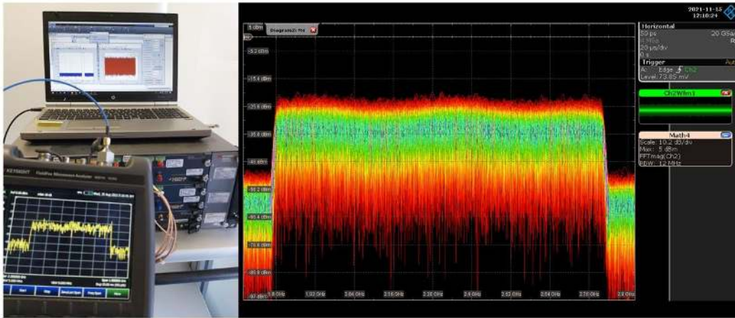
Şekil 4.6 a) Gürültü Sinyalinin Oluşturulması b) Sinyalin Ölçüm Sonucu
