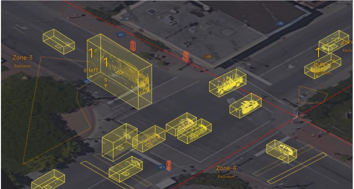
Şekil 3.9. LIDAR sensör algılama çıktısı (Ouster, 2024)
