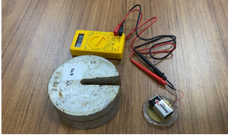
Şekil 4.16. Hücresel yük yöntemi deneyi için tasarlanan test düzeneği
