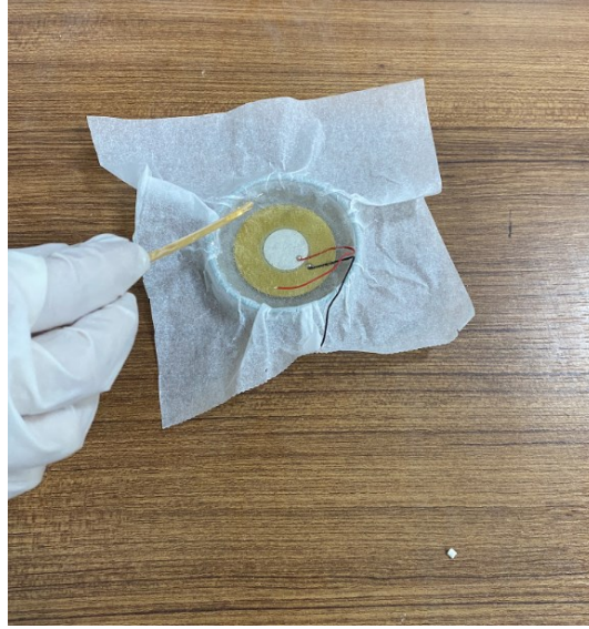
Şekil 4.12. Üst tabakanın oluşturulması
