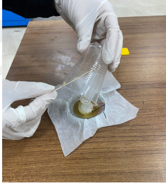
Şekil 4.11. Piezoelektrik seramiğin yerleştirilmesi
