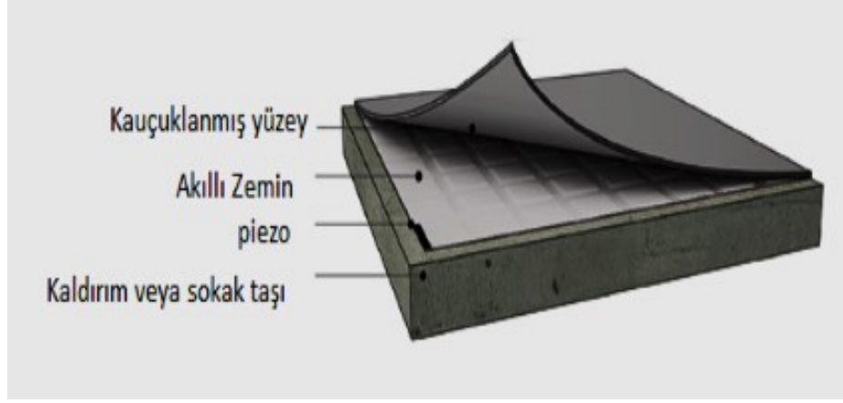
Şekil 4.1. Piezoelektrik malzemenin platformda kullanımı
