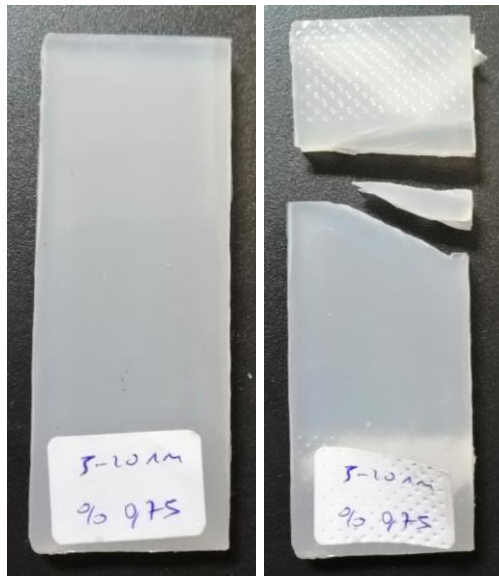
Resim 26. Kütlece %0,75 oranında 5-20 nm boyutunda silisyum dioksit katkılanmış epoksinin çekme testi öncesi ve sonrası
