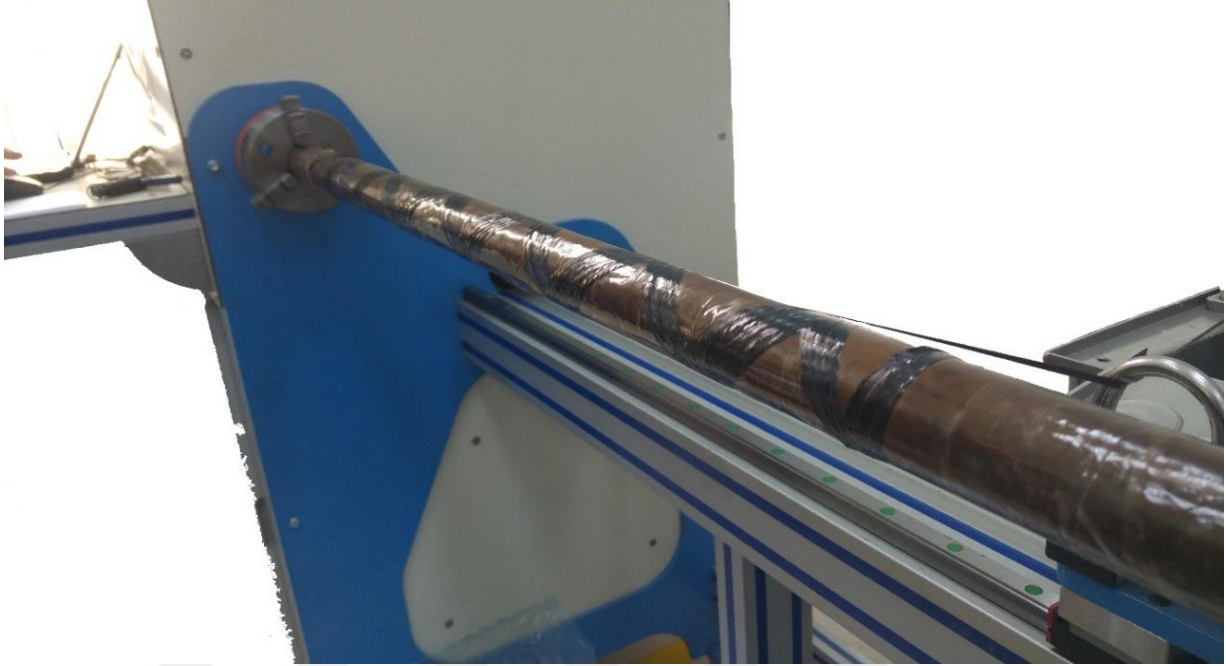
Resim 6. Filament sarma metodu ve üretilmekte olan fiber takviyeli epoksi reçine boru (Erarslan ve diğerleri, 2017).
