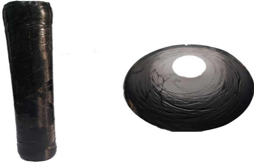
Resim 3. Elyaf sarma metodu ile üretilen karbon fiber (elyaf) takviyeli epoksi reçineden elde edilmiş bir boru (Erarslan ve diğerleri, 2017).
