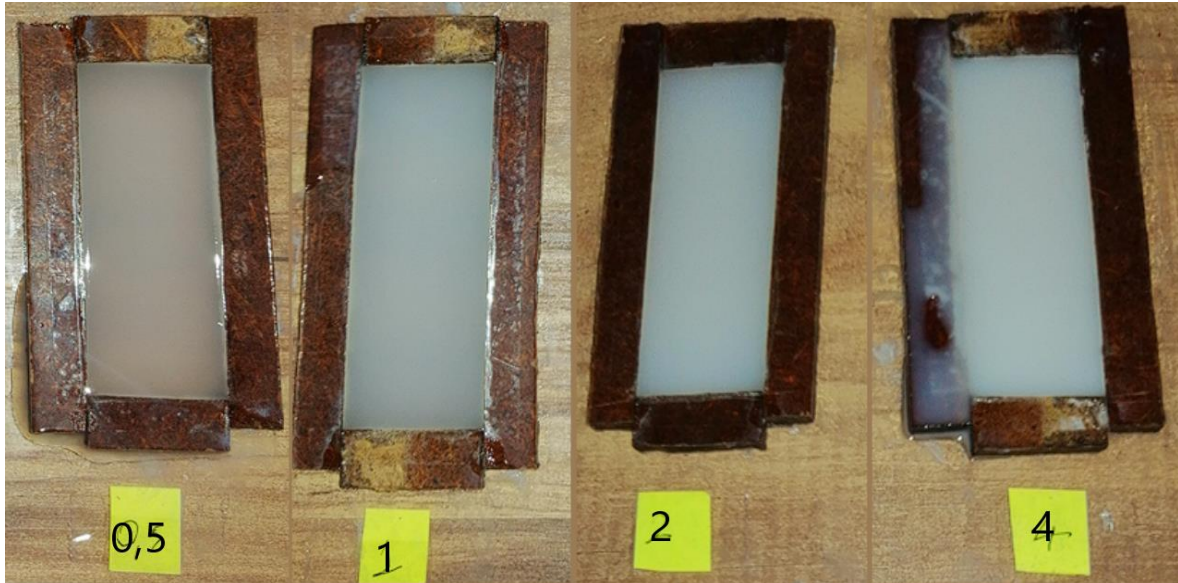
Resim 13. Kütlece %0,5- %1- %2 ve %4 miktarında 80 nm boyutlarındaki silisyum dioksit tanecikleri ile katkılanmış epoksi (Ep/Se = 2/1) numunelerinin dökümü (kütlece %0,25 daha sonra yeniden dökülmüştür)
