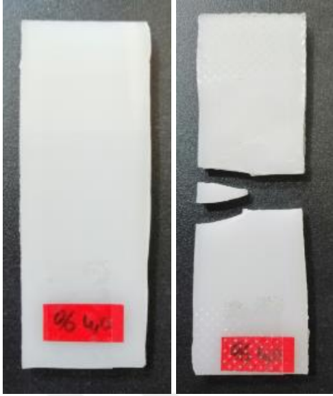
Resim 23. Küttelece %4,00 oranında 80 nm boyutunda silisyum dioksit katkılanmış epoksinin çekme testi öncesi ve sonrası
