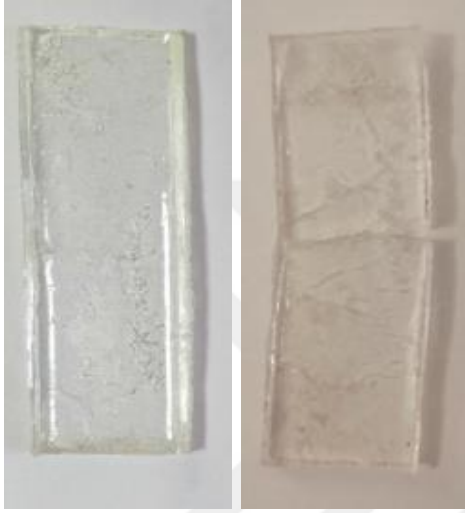
Resim 15. 1/1 oranında Epoksi/Sertleştirici numunesinin çekme testi öncesi ve sonrası
