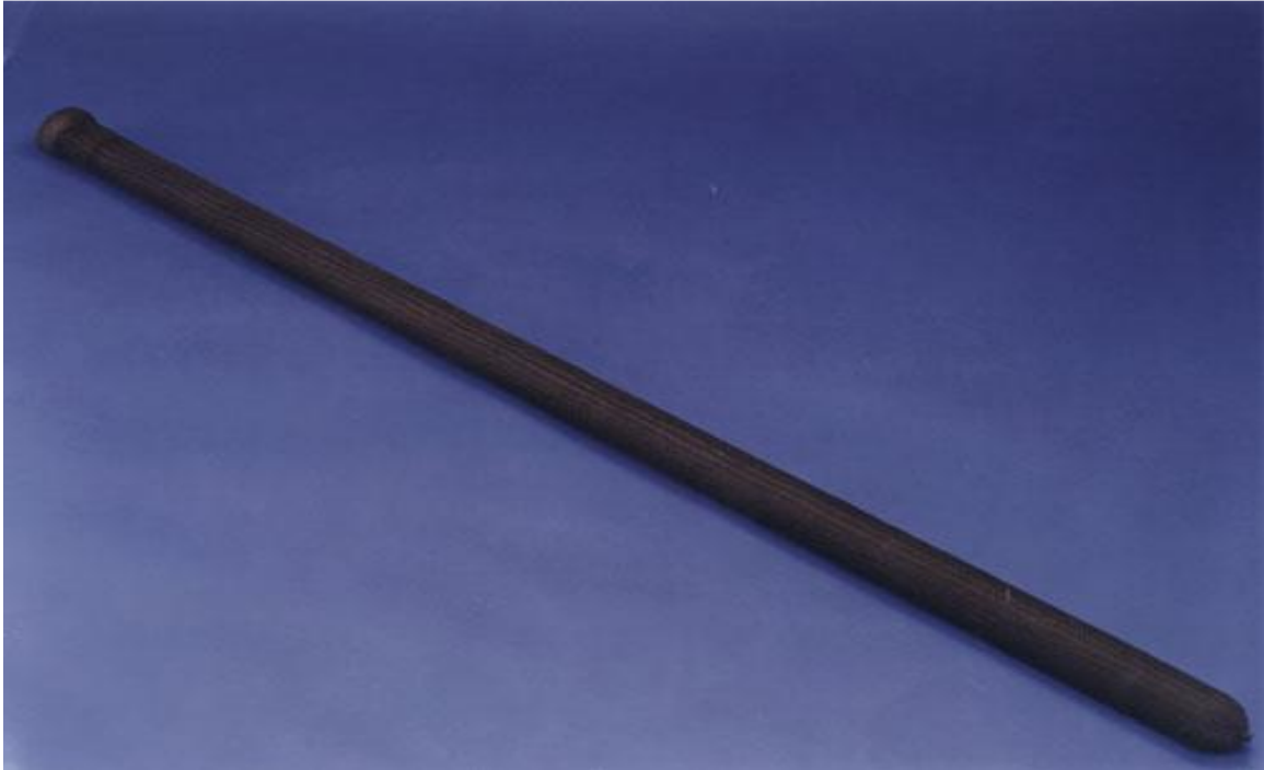
Resim 2. Silisyum karbür matrikste Nextel™ 312 seramik fiberlerden oluşan mum tipi bir filtre (Chawla, 2012).
