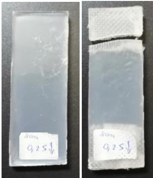
Resim 19. Kütlece %0,25 oranında 80 nm boyutunda silisyum dioksit katkılanmış epoksinin çekme testi öncesi ve sonrası
