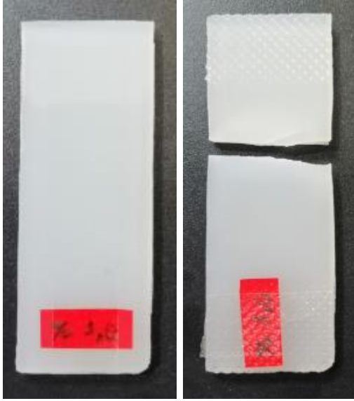
Resim 21. Küttelece %1,00 oranında 80 nm boyutunda silisyum dioksit katkılanmış epoksinin çekme testi öncesi ve sonrası
