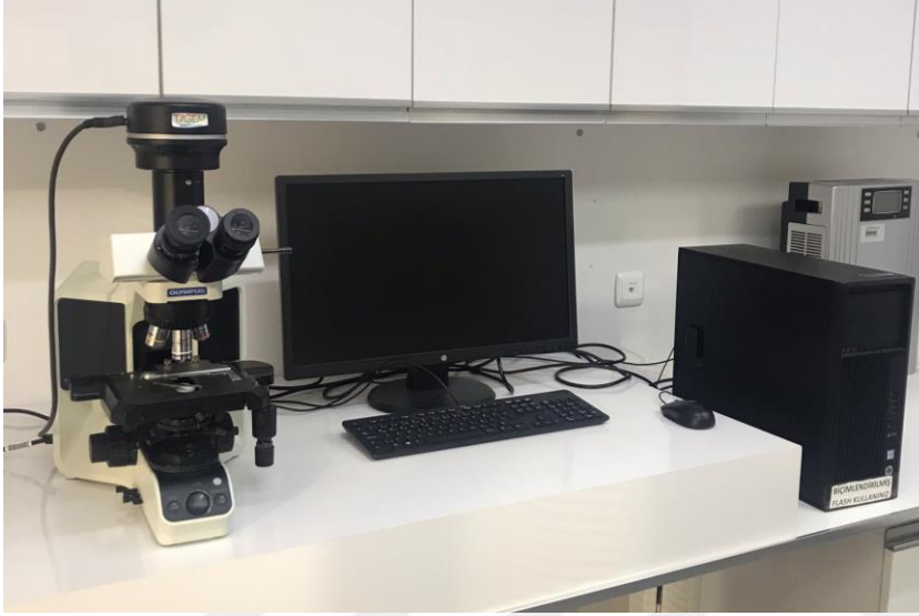
Resim 2.13. Olympus BX53 mikroskop, Olympus DP74 kamera ve Olympus cellSens Entry görüntüleme sistemi (orijinal).
