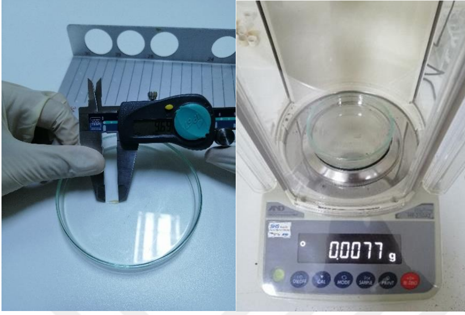
Resim 2.43. Boy ve ağırlık ölçümlerinin yapıldığı dijital kumpas ve hassas terazi (orijinal).
