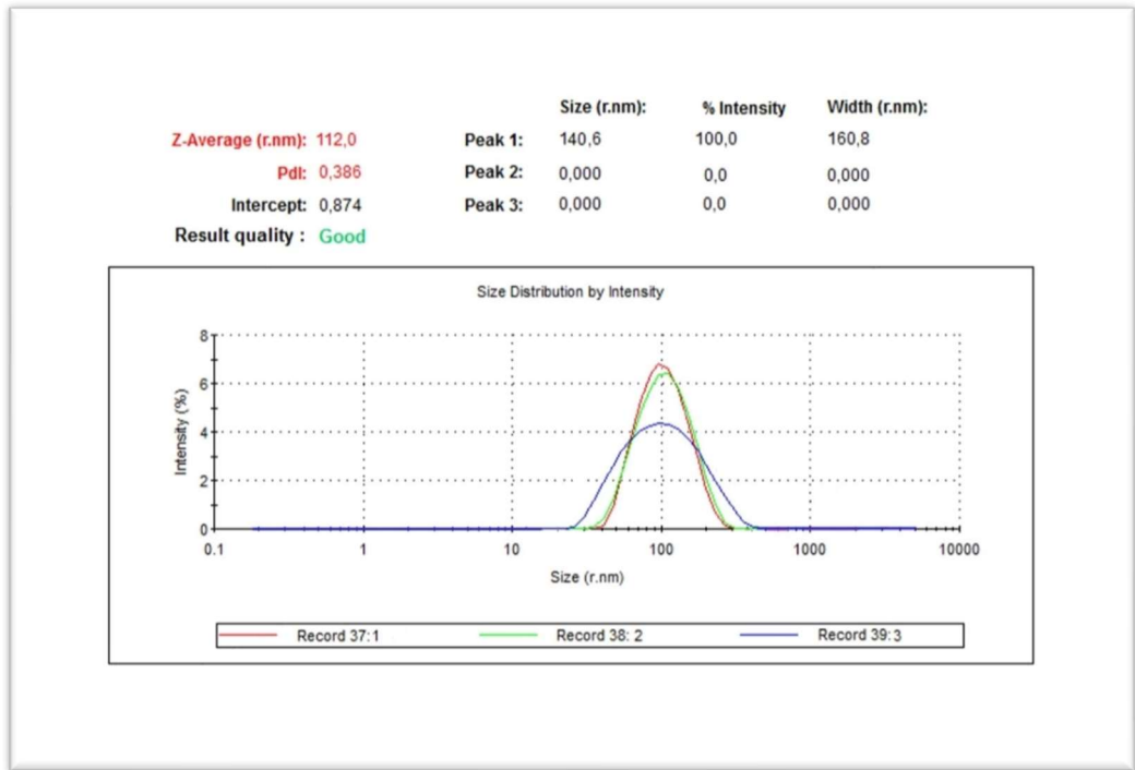
Şekil 5.6. ÇG ile elde edilen eksozomların Malvern Zeta Sizer cihazı ile Partikül boyutu (r.nm) ve Partikül boyut Dağılımı (PDI) analizi sonuçları
