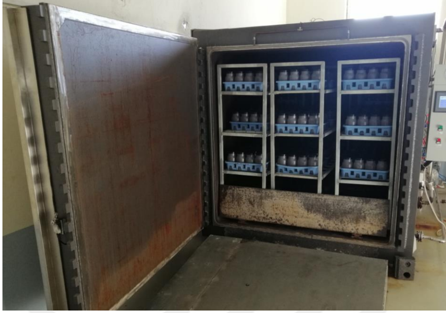
Fotoğraf 3.4. Yetiştirme ortamlarının otoklavda steril edilmesi.
