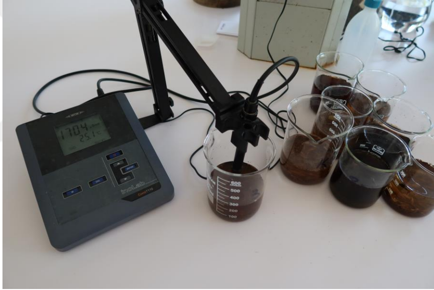
Fotoğraf 3.8. Tuzluluğun ölçülmesi.
