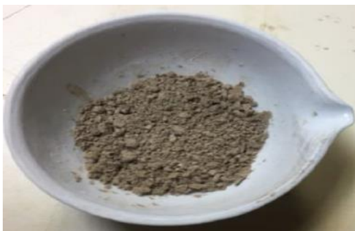
a) Lime-water-sodium lignosulfonate
