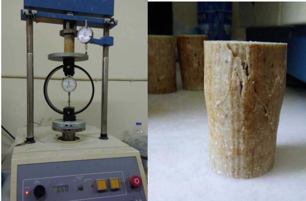
Şekil 31. Kırım sırasındaki ve kırım sonucundaki doğal zemin numunesi
