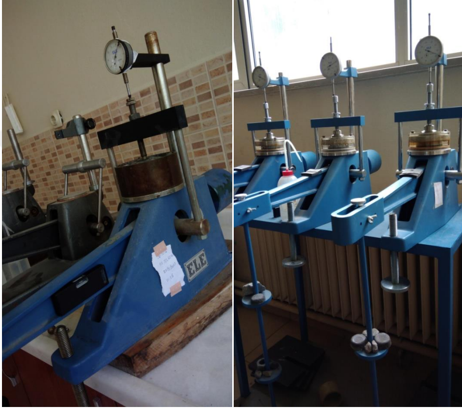
Şekil 44. Ödometre aleti ile şişme potansiyelinin belirlenmesi
