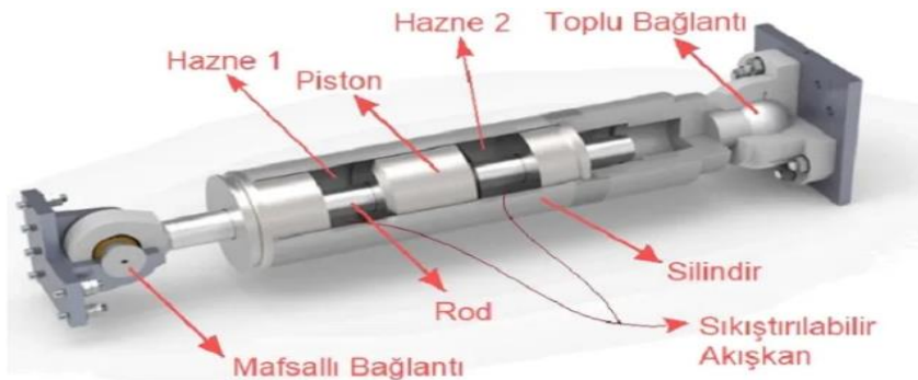
Şekil 18. Viskoz damper bileşenlerinin şematik detaylandırması
