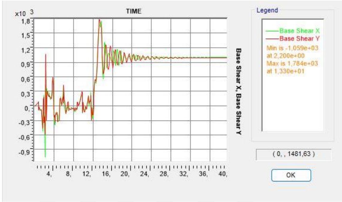
Şekil 6.7. Sismik İzolatörlü çelik yapı taban kesme kuvveti
