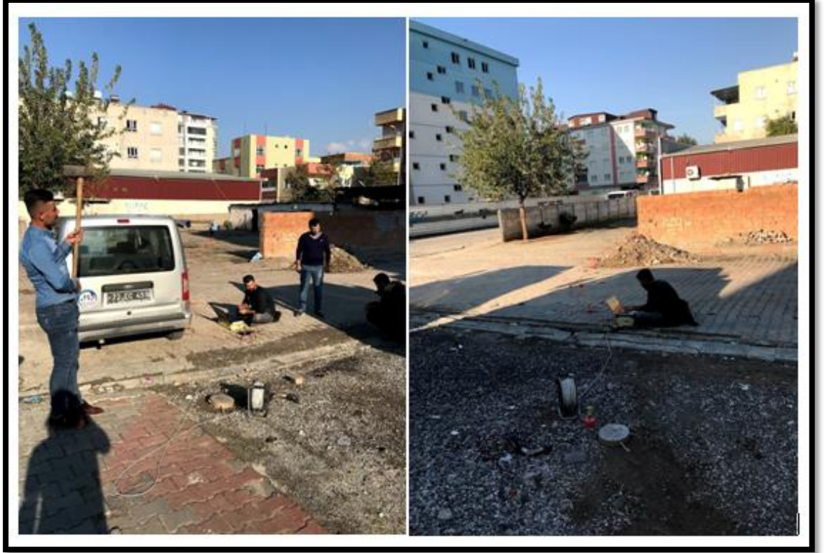
Şekil 4.31.İnceleme alanında yapılan sismik yöntem ölçüm çalışmaları
