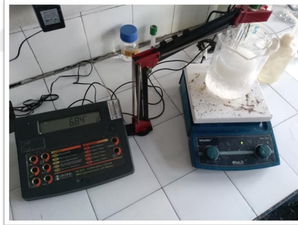
Şekil 6: Sentez için hazırlanmış olan deney düzeneği. Buz banyosu içinde manyetik karıştırıcıda karışmakta olan sodyum kazeinat dispersiyonu ve pH kontrolü için sabitlenmiş pH metre.
