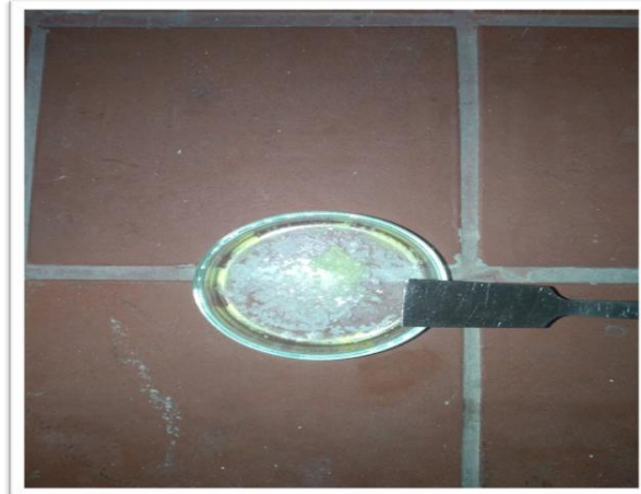
Şekil 10: Vakumlu etövde kurutulmuş sisplatin çözöltü ve çöken toz sisplatin.
