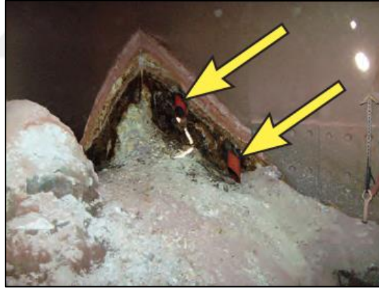
Resim 3.4 Nozüllerin şut duvarına gömülü olarak konumlandırılması (İnt.Kyn. 3).
