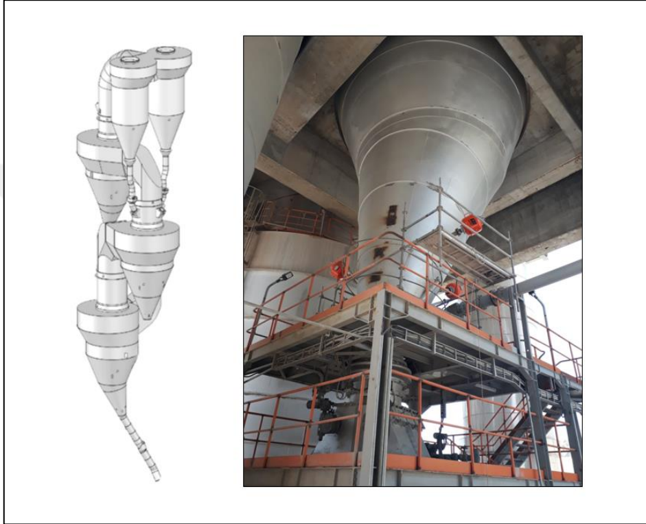
Resim 6.13 Örnek bir siklon teknik kesiti ve hava şoku uygulaması görseli (İnt.Kyn. 7).
