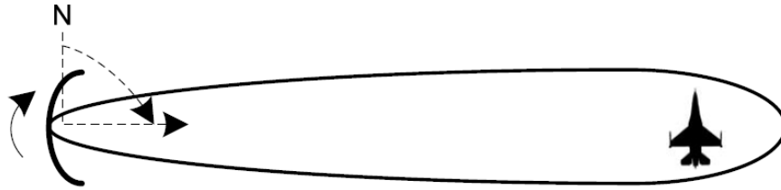
Şekil 2.9. Elektromanyetik Enerjinin Düz Bir Hat Boyunca İlerlemesi [15].
