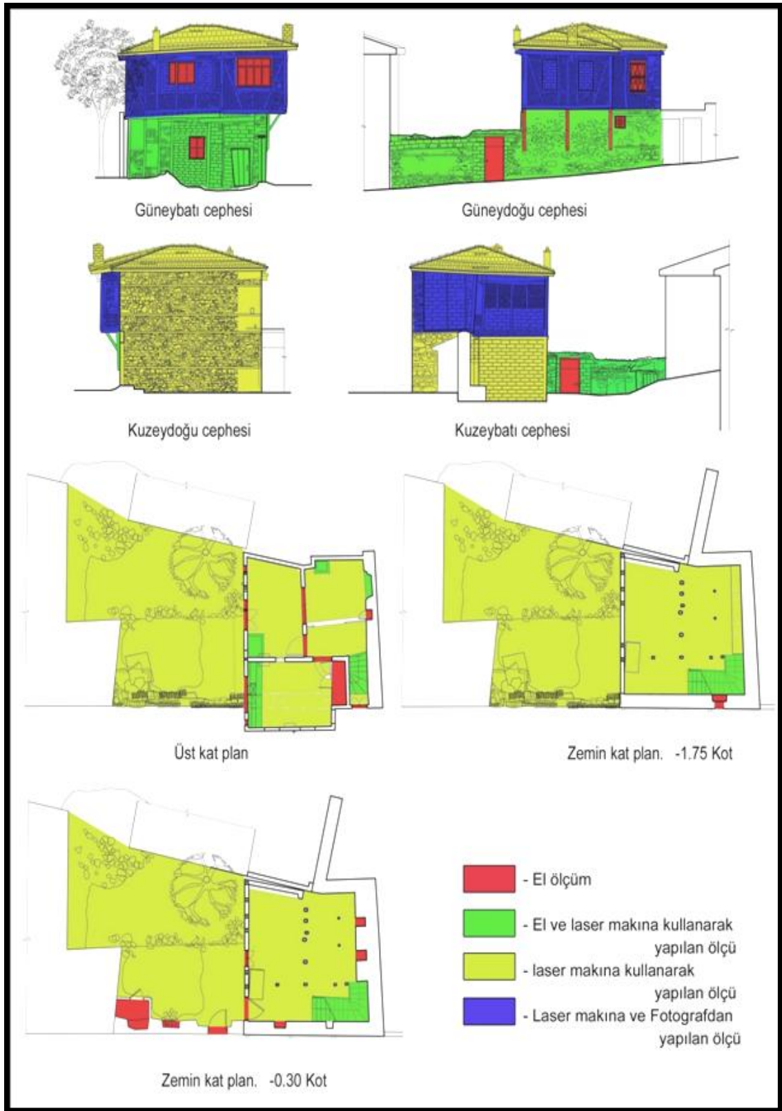
Şekil 4.1. Yapının farklı bölümlerinde kullanılan ölçüm teknikleri.
