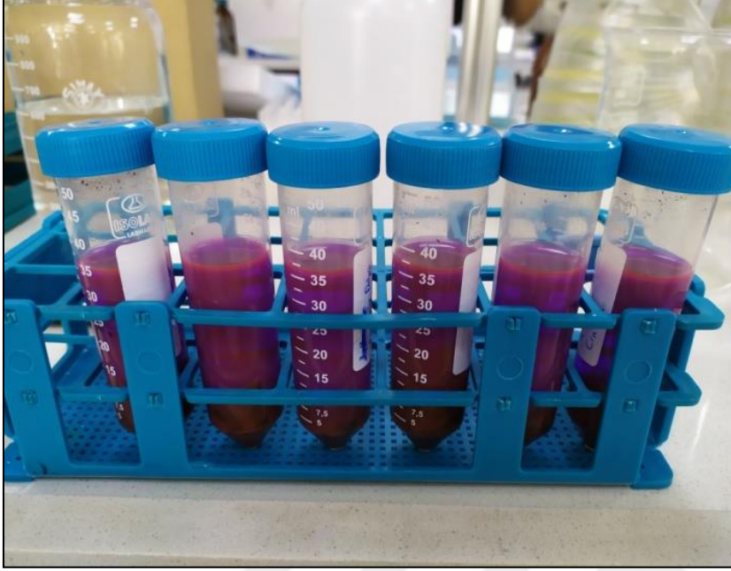
Şekil 2.7 FE, Tris-HCl tamponu ile dondurma ve çözme metodu
