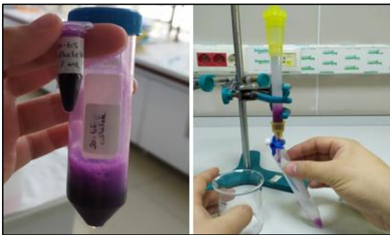
Şekil 2.11. Elde edilen çökeğin Sephadex G-25 kolondan geçirilme işlemi
