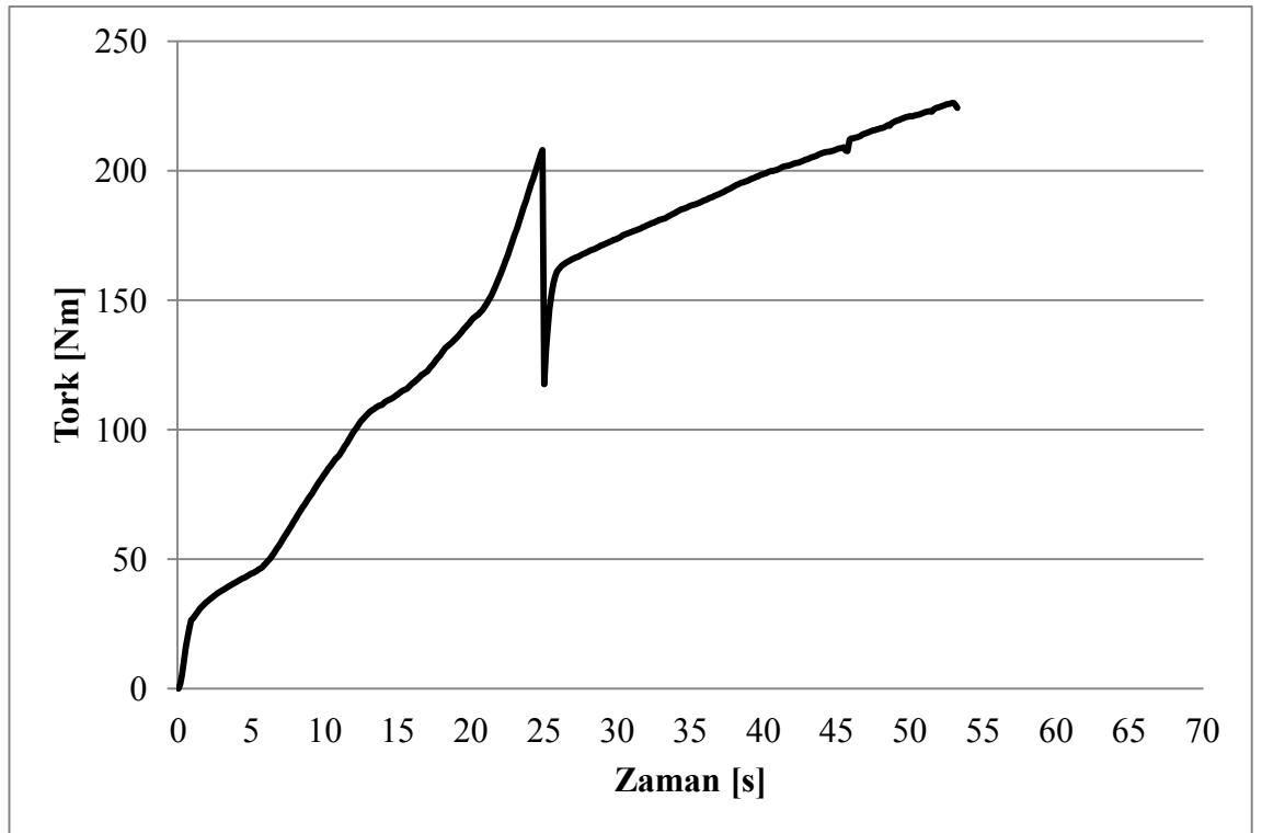
Şekil 4.55. D55 no.lu deneyin tork-zaman grafiği
