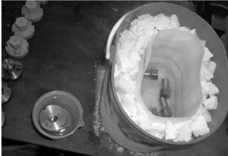
Şekil 2.5. Sıcak geçme (shrink - fit) yöntemi uygulanarak parçaların montajı (Booker ve Truman 2020)
