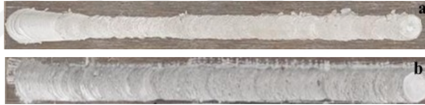
Şekil 3.3.a) SKP ile üretilen takviyesiz Ti13Nb13Zr alaşımı, b) SKP ile üretilen HA takviyeli Ti13Nb13Zr/HA kompozit
