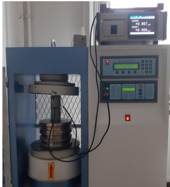
Şekil 5.7. Tek eksenli sıkışma dayanımı deneyi sırasında boyuna ve enine deformasyonların ölçümü
