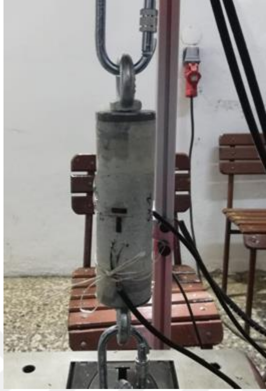
Şekil 5.14. Doğrudan çekme dayanımı deneyi sırasında boyuna ve enine deformasyonların ölçümü
