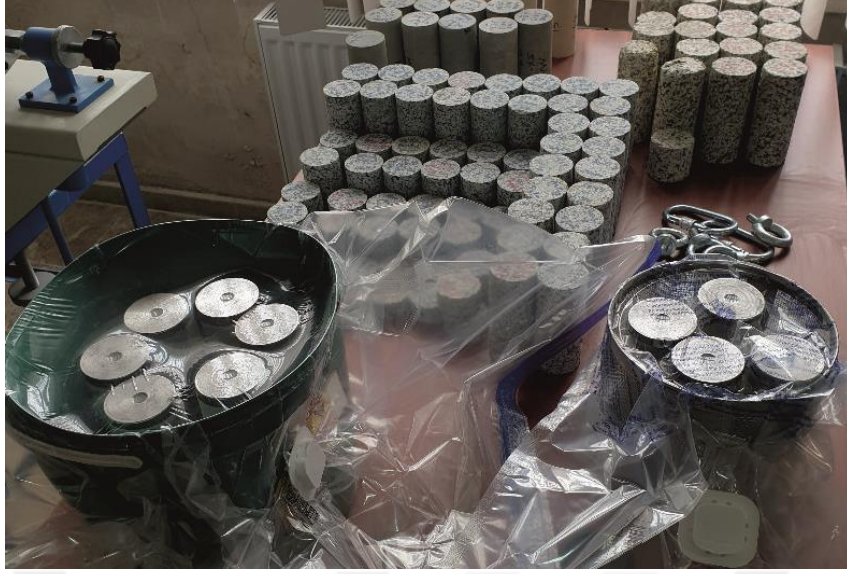
Şekil 5.12. Çelik başlıkların yapıştırıldığı örneklerin vakumlu ortamda bekletilmesi
